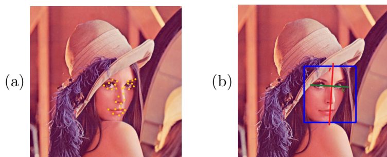
FIGURE 2.7 – Exemple de détection de visage par analyse d’image : (a) détection des éléments du visage (en jaune), (b) le visage détecté (en bleu), l’axe horizontal du plan du visage (en vert) et l’axe vertical (en rouge).
