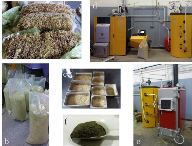
Figure 41 - Photographies des dispositifs liés aux changements d'échelle de l'étape de combustion de la biomasse de l'hyperaccumulateur de nickel O. chalcidica : bottes récoltées en champs (a), plantes broyées (b), granulés de biomasse (c), appareil de combustion à tapis roulant (d), appareil de combustion pour botte entière (e), cendres produites (f) (adaptée de [COS1])
