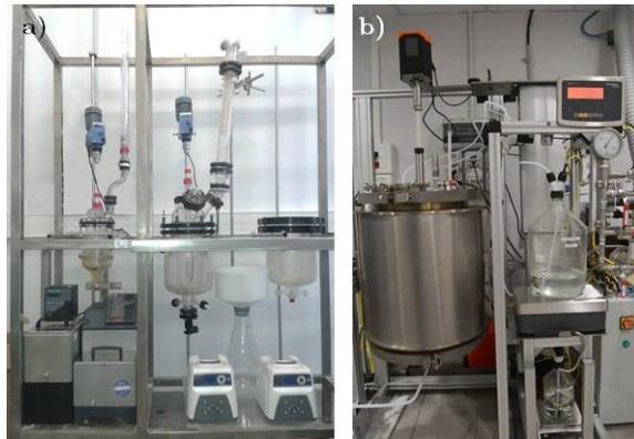
Figure 42 - Photographies des pilotes de transformation des cendres d'hyperaccumulateurs : pilote de laboratoire (a), petit pilote de production (b) (adaptée de [COS1])
