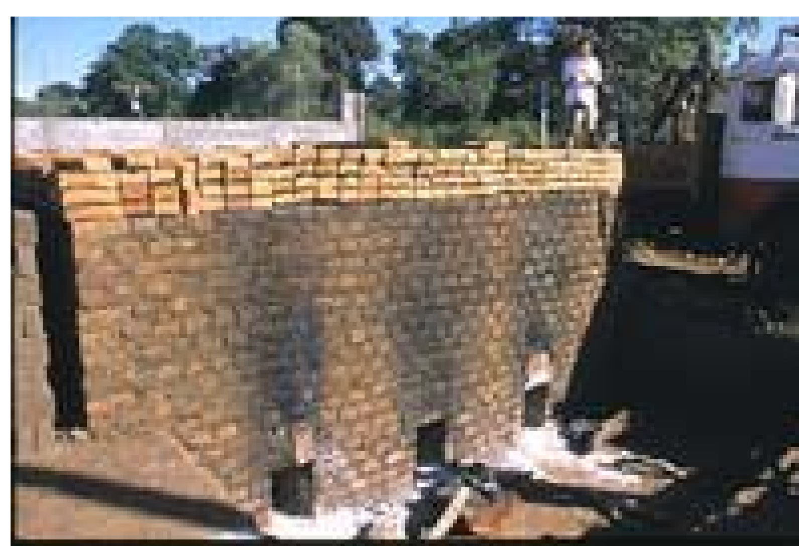
Figure 14 : Four de cuisson pour les briques de terre.
