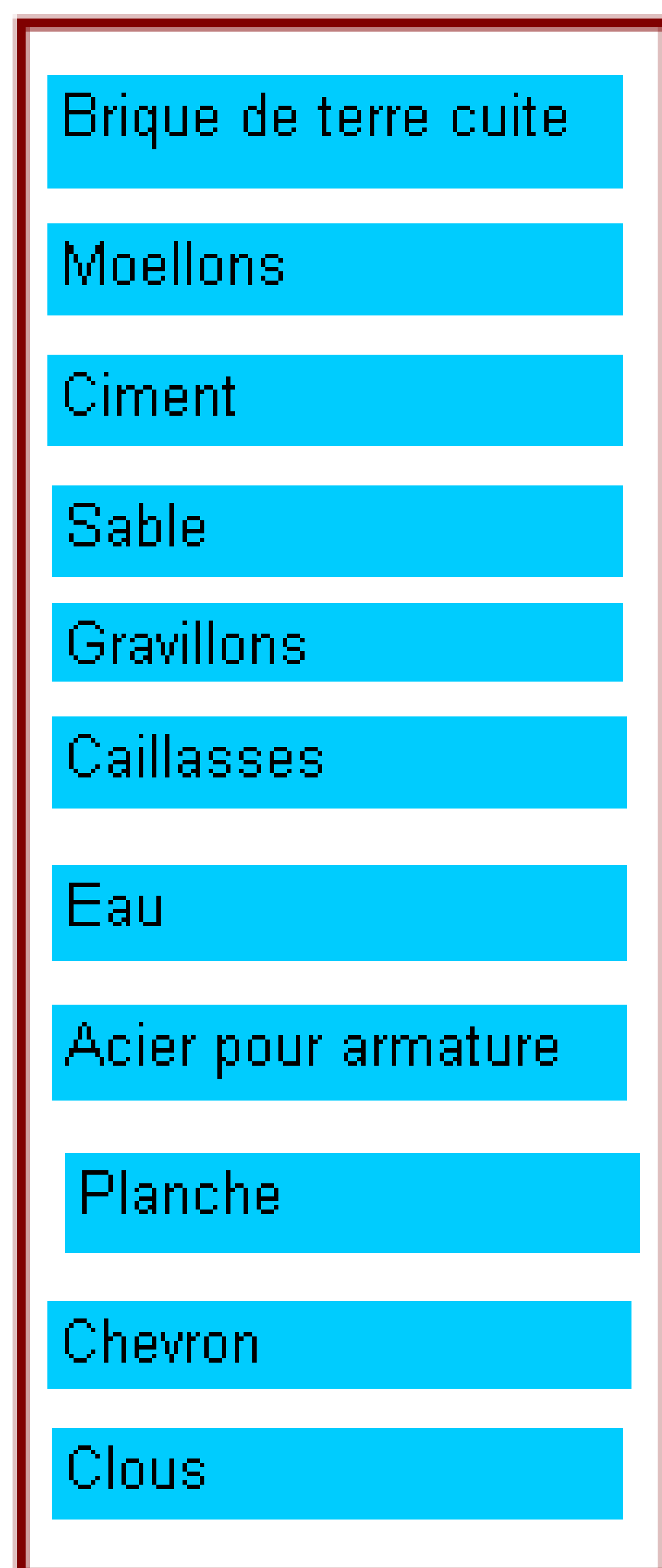
Figure 41: Les éléments de départ et produits finaux de l'ouvrage fonctionnel fondation.
