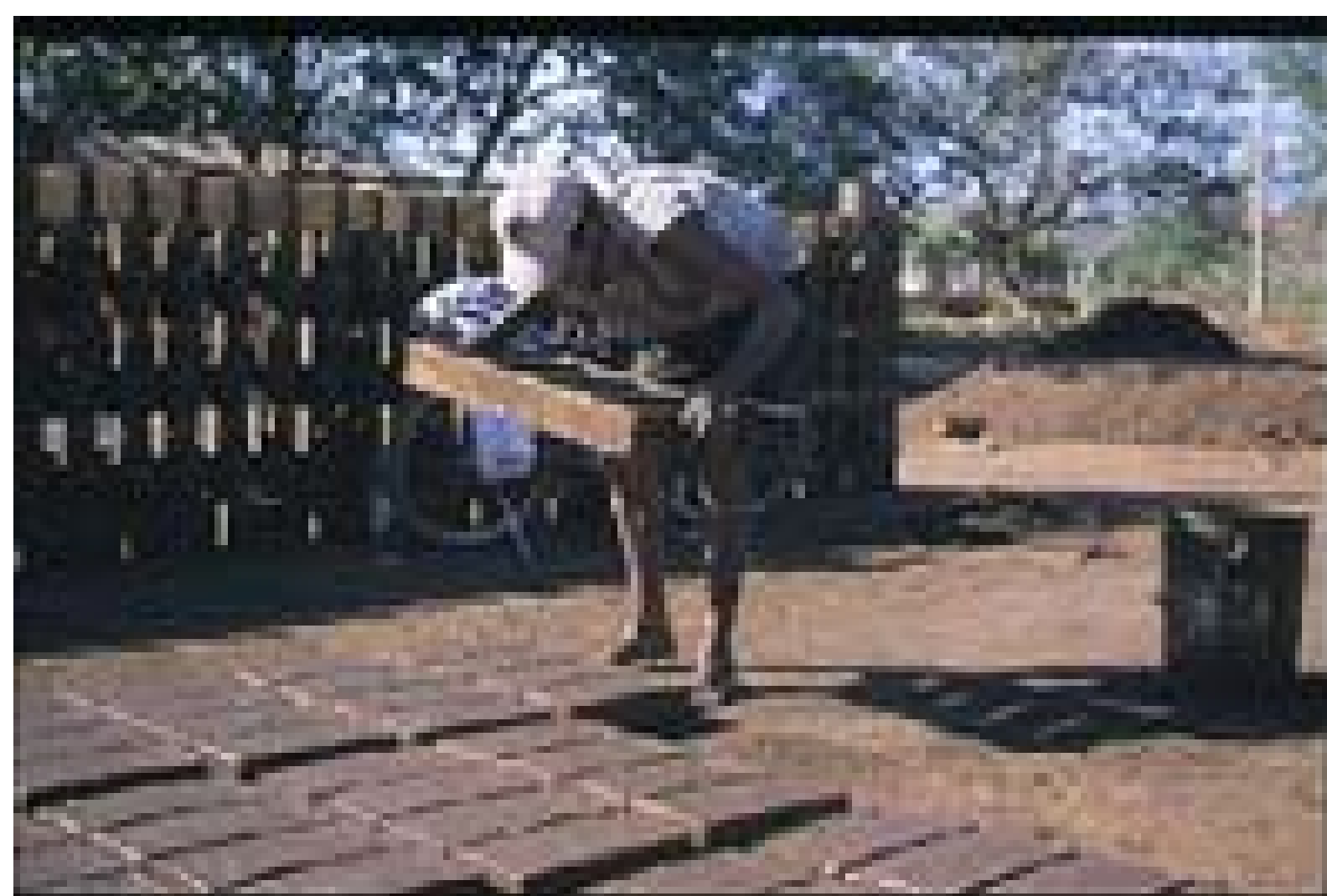
Figure 13: Moulage et des briques de terre avant cuisson.
