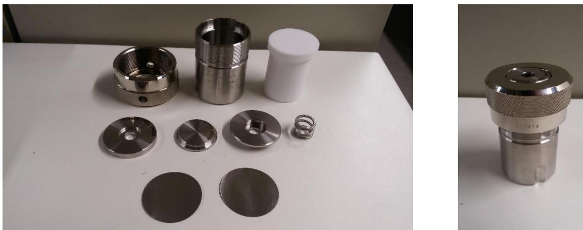
**Figure III-9 :** (*Gauche*) Image des éléments constitutifs de l'autoclave utilisé pour les synthèses solvothermales de  $\text{LiNbO}_3$  (disques de rupture et de corrosion en première rangée, disques de pression en deuxième rangée, tête et corps de l'autoclave et réacteur téflon en dernière rangée) et (*Droite*) image de l'autoclave une fois assemblée.
