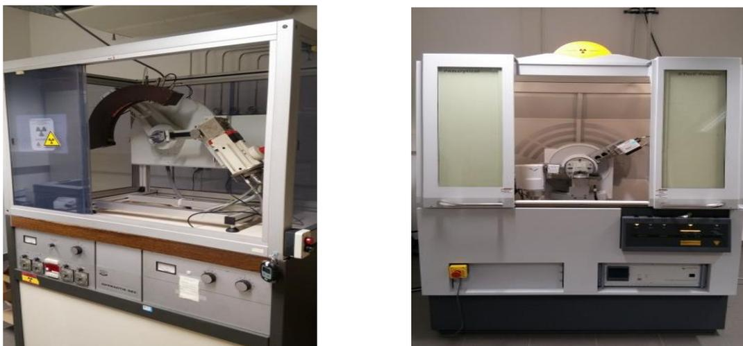
Figure III-13 : Comparaison des diffractomètres INEL (à gauche) et X'Pert<sup>3</sup> de Malvern-Panalytical (à droite).
