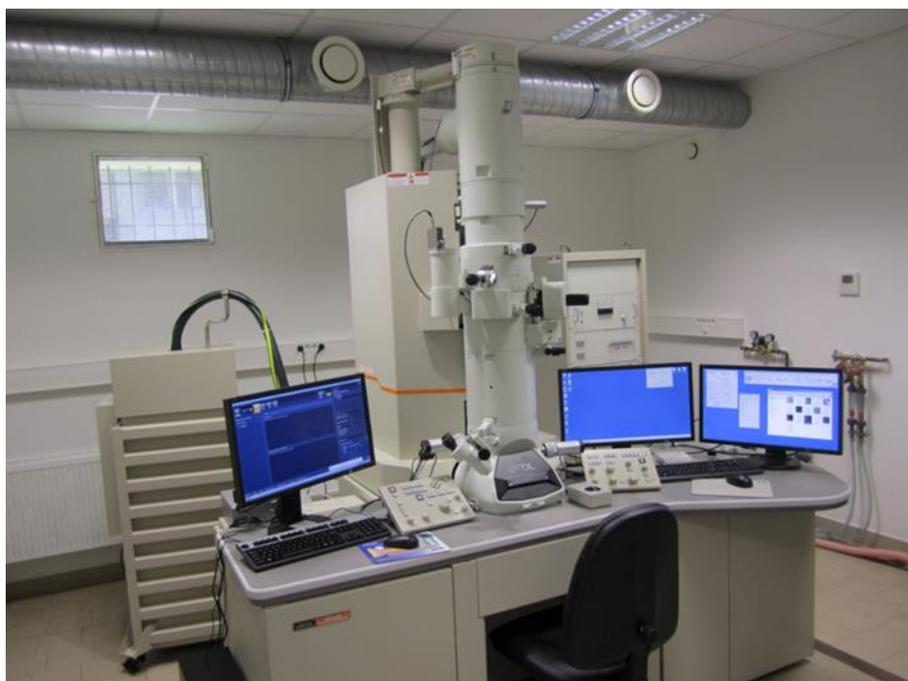
**Figure III-16** : Microscope électronique en transmission JEOL 2100 HT utilisé pour l'imagerie des échantillons.
