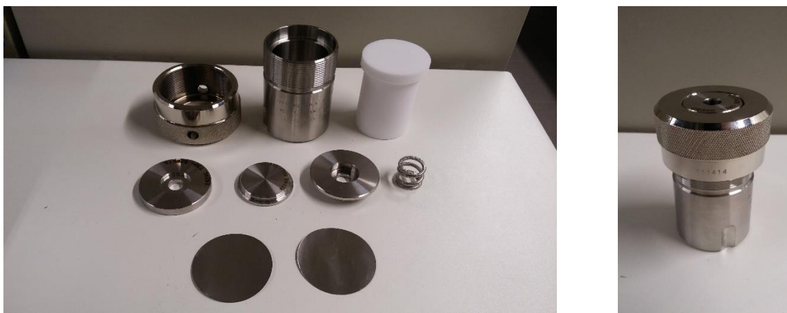
Figure III-9 : ( Gauche ) Image des éléments constitutifs de l'autoclave utilisé pour les synthèses solvothermales de \text{LiNbO}_3 (disques de rupture et de corrosion en première rangée, disques de pression en deuxième rangée, tête et corps de l'autoclave et réacteur téflon en dernière rangée) et ( Droite ) image de l'autoclave une fois assemblé.
