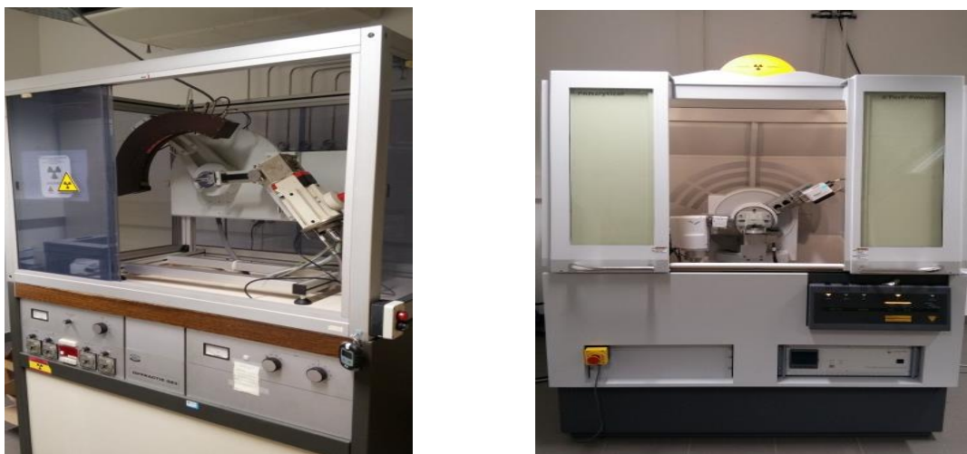
Figure III-13 : Comparaison des diffractomètres INEL (à gauche) et X'Pert 3 de Malvern-Panalytical (à droite).
