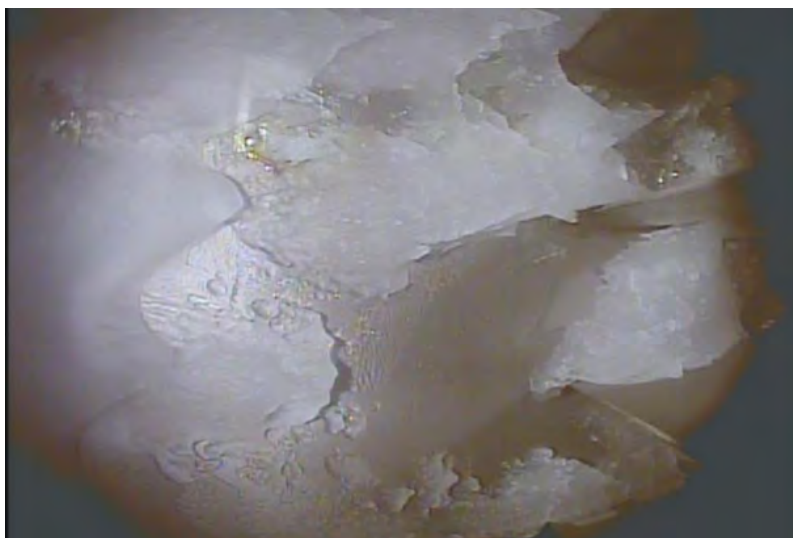
FIGURE 3. – Image de l'accrétion de glace en tête des aubes EGV (Exit Guide Vane) et sur la virole extérieure à la sortie du compresseur basse pression de l'ALF502-R5 obtenue lors de la campagne d'essai au PSL - D'après Veres et al. [153]
