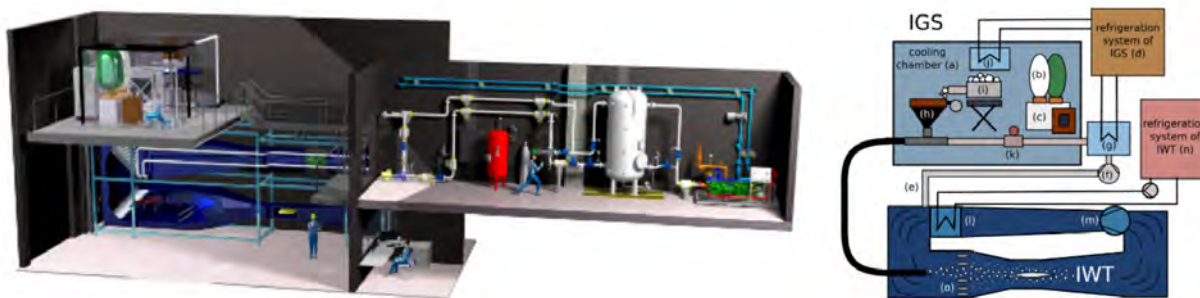
FIGURE 1.14. – Illustration de la soufflerie givrante de l'Université de Braunschweig (à gauche) avec son système de production des cristaux (à droite) - Adaptée de Baumert et al. [15]
