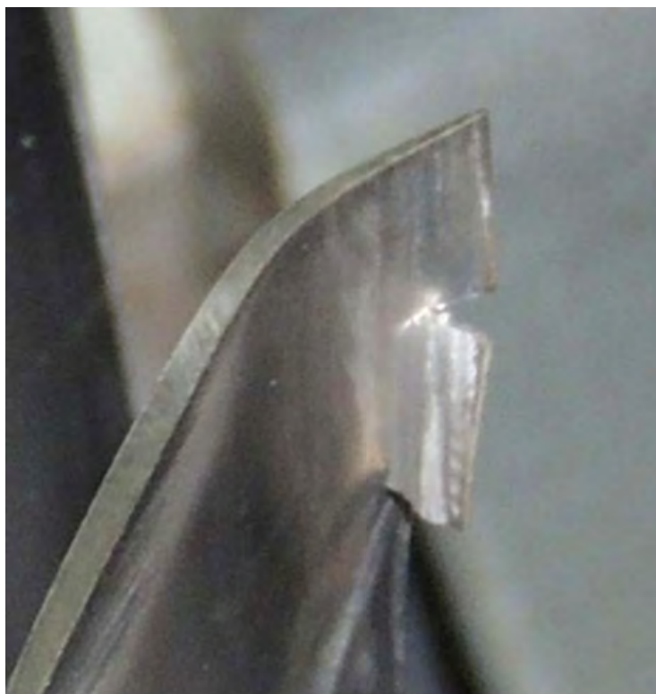
FIGURE 2. – Exemple de l'endommagement d'une aube de compresseur haute pression par l'impact d'un bloc de glace formé en conditions givrantes cristaux - D'après Oliver et al. [109]
