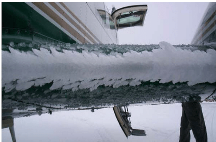
FIGURE 1. – Exemple de l'accumulation de givre provoquée par l'impact de gouttelettes d'eau liquide surfondue sur le bord d'attaque d'une aile d'avion - D'après Tytelman [150]
