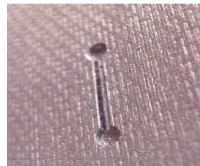
FIGURE 5.28 – Rainure vide à la surface extradados d'une des gouvernes [119]
