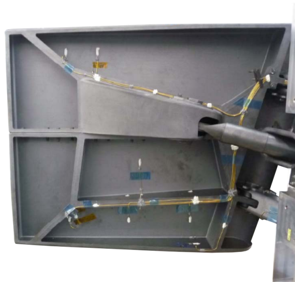
FIGURE 5.26 – Gouverne gauche de l'IXV, vue de dessus (surface extradados), avec le montage des thermocouples sur sa surface extradados [113]
