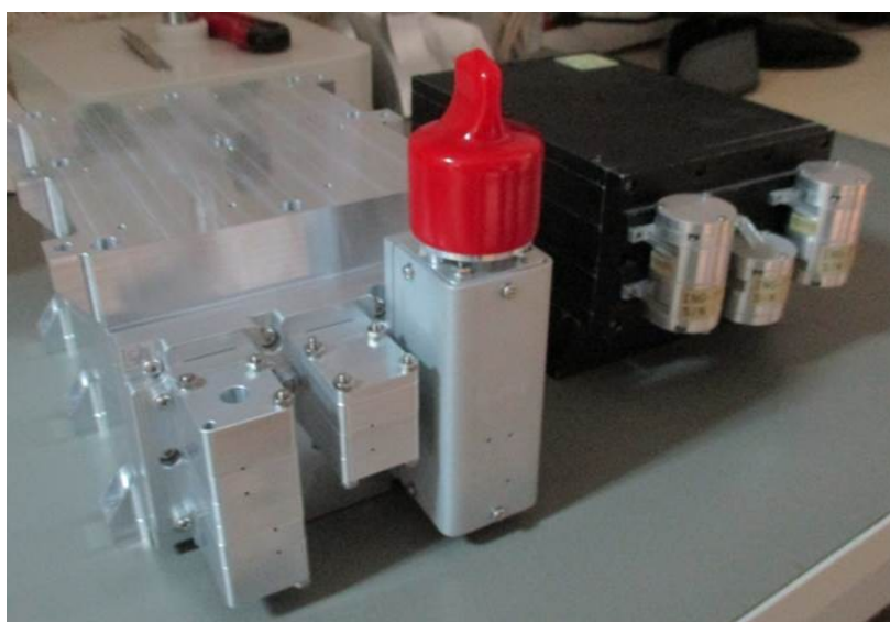
Figure IV.22: Modèle d'essai du moniteur de radiations ICARE-NG 2 équipé de la tête de détection de protons de basses énergies (gauche) et le moniteur ICARE-NG (droite). Crédits : EREMS.
