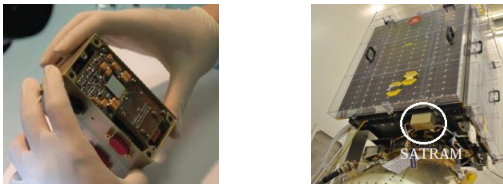
Figure III.19: Instrument SATRAM sans le blindage supérieur afin de visualiser la puce Timepix ainsi que l'électronique (gauche), et position de l'instrument SATRAM sur le satellite Proba-V (droite).
