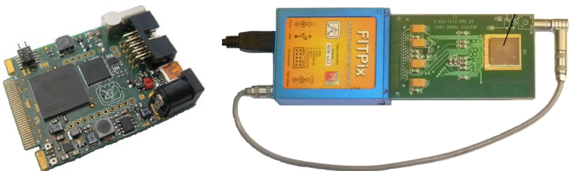
Figure III.17: Électronique du FITPix [72] (gauche) et le FITPix branché à la puce Timepix [73] (droite).
