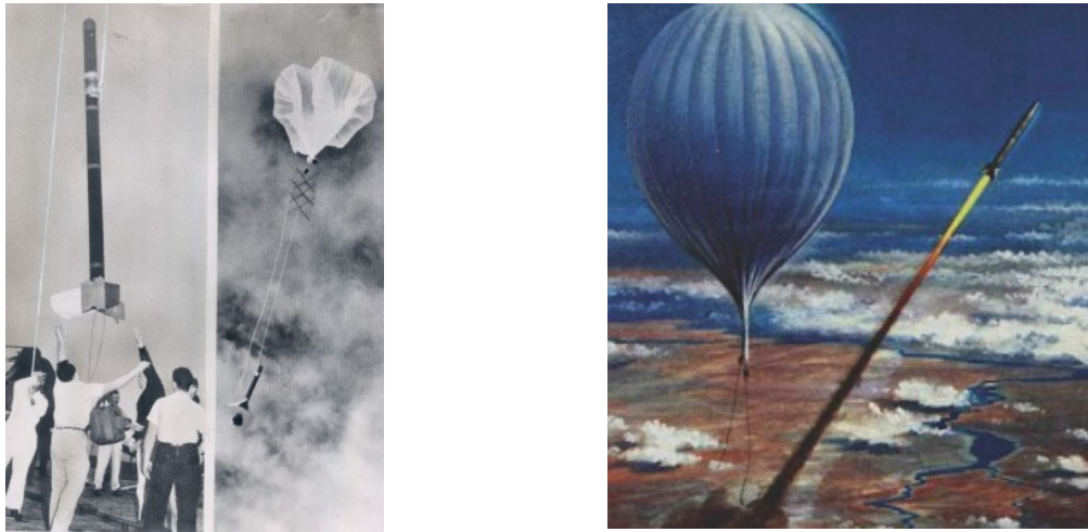
Figure I.16 : Illustration d'un lancement d'une fusée-sonde à l'aide d'un ballon (gauche) et d'un allumage d'une fusée-sonde lorsque le ballon a atteint l'altitude de lancement (droite).
