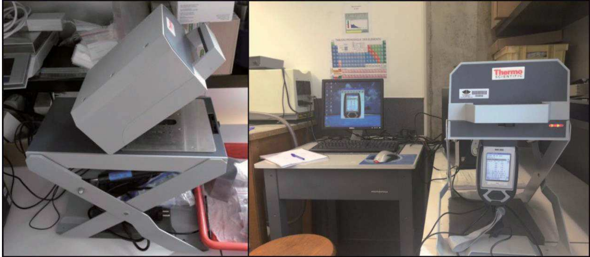
Fig.7. 6: Dispositif de mesures de la fluorescence X au laboratoire (stand portable NIT-420-017).
