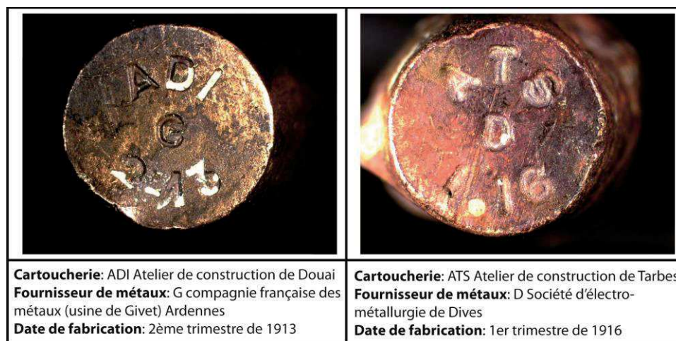
Fig.6. 24: Etude balistique sur les ogives dans l'entrée de la carrière d'Hermonville (Source : Cliché Barbin V.).
