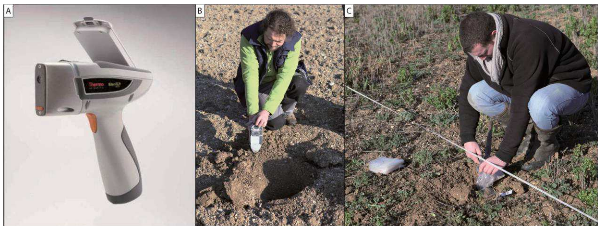
Fig.7. 5: A - Analyseur par fluorescence X portable Niton XL3t 980 GOLDD+ (Source : Thermo Niton). B – Mesure sur le terrain par fluorescence X à Isle-sur-Suipe (Source : cliché Devos A.). C – Prélèvement d'échantillon à Isle-sur-Suipe (Source : cliché Devos A.)
