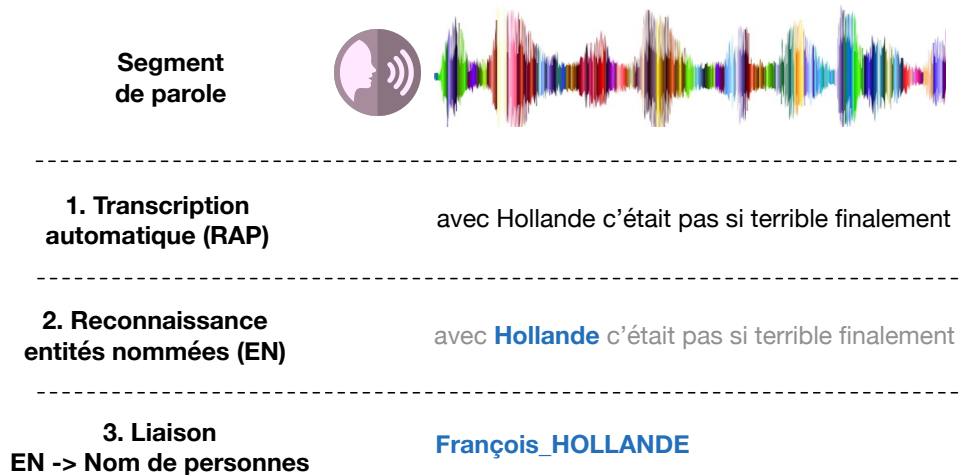
FIGURE 5.1 – Modules pour la reconnaissance des noms de personne à partir du signal audio au travers d'un exemple.
