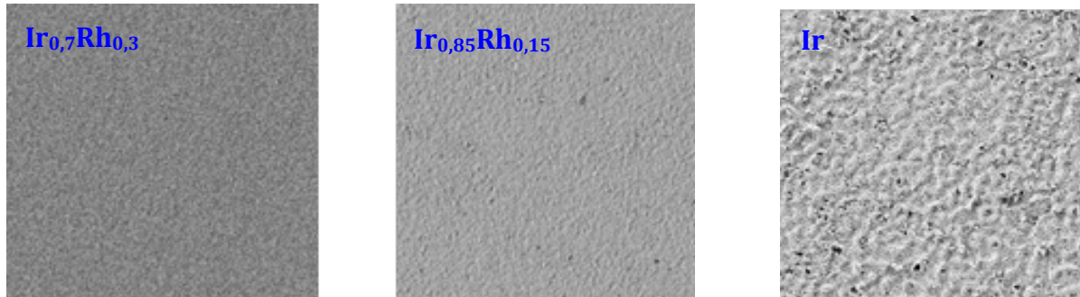
Figure 2.29 : Images MEB de la surface des films minces de type \text{Ir}_{0,7}\text{Rh}_{0,3} (image de gauche), \text{Ir}_{0,85}\text{Rh}_{0,15} (image centrale) et d'iridium pur (image de droite), à l'issue d'un recuit de 4 jours à 800^\circ\text{C} suivi d'un autre de 7 jours à 900^\circ\text{C} .
