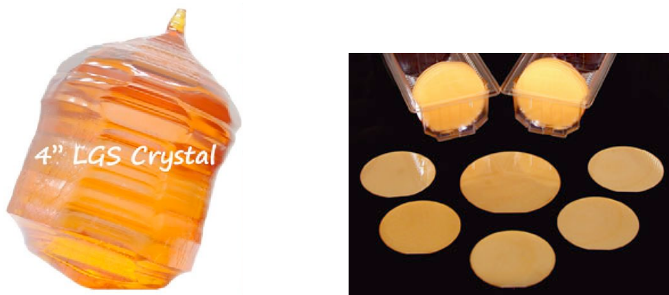
Figure 1.2 : Boule (à gauche) et wafer de 3 et 4 pouces de diamètre (à droite) de LGS. 8
