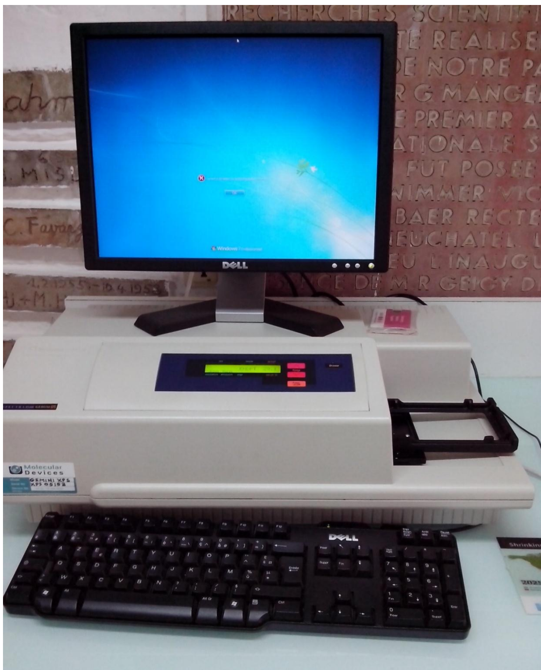
Figure 17 : Spectrofluorimètre (Spectra max GEMINI XPS) utilisé pour la mesure de l'activité antipaludique (Photographie TUO, 2014)
