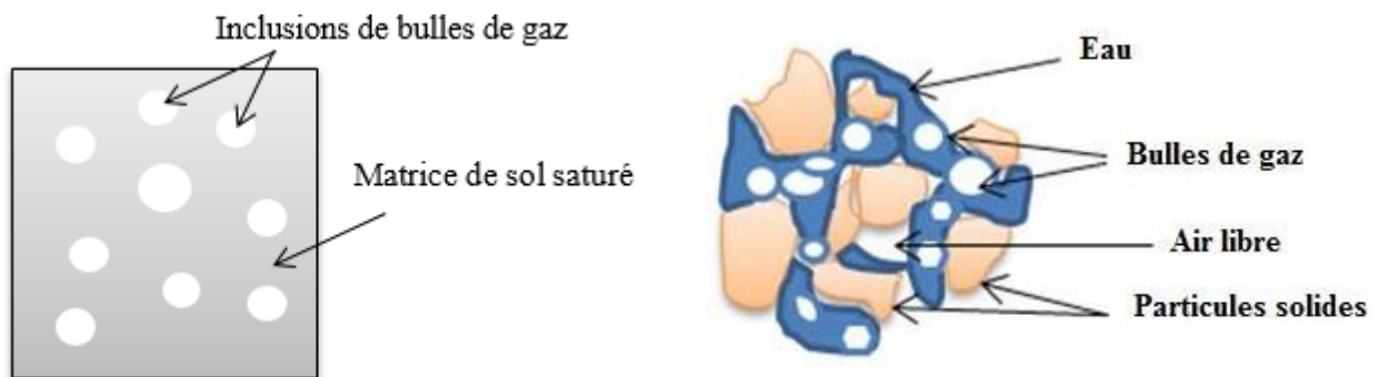
b- Modèle adopté pour étudier l'écoulement de la mousse dans un sol sableux
