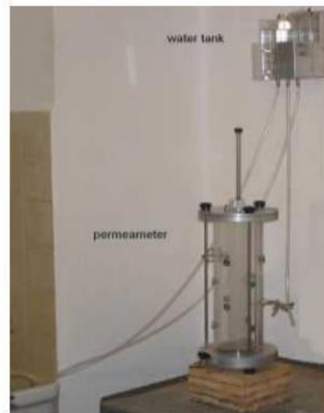
Figure 15 : Schéma du dispositif de perméabilité utilisé pour un sol traité (Borio and Peila 2010)
