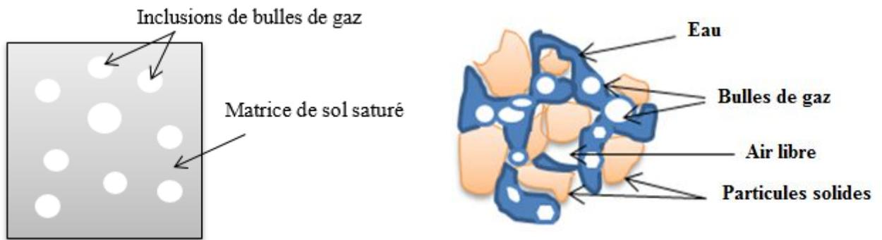
a- *Modèle adopté pour le comportement mécanique d'un sol sable argileux (cas du sol 40% Kaolin + 60% sable) traité avec la mousse*
