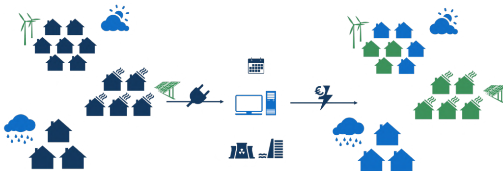
Figure 1.14 – Illustration d’une itération du protocole de pilotage de la demande électrique pour une population non-homogène. En entrée, l’algorithme reçoit des variables contextuelles de chaque groupe, une consommation cible globale (la production d’électricité), ainsi que certaines cibles locales (induites par exemple par la production d’énergie solaire ou éolienne). Il a accès à l’historique de consommation de la population (avec les variables contextuelles et les tarifs choisis sur les itérations passées). Pour chaque groupe, il choisit alors les tarifs à envoyer ainsi que leurs proportions respectives. Sur cet exemple, il ne scinde que les groupe du haut, à qui il envoie le tarif bleu au 4/7 du groupe et le tarif vert au 3/7 restant, le groupe du milieu reçoit le tarif vert et celui du bas le bleu.
