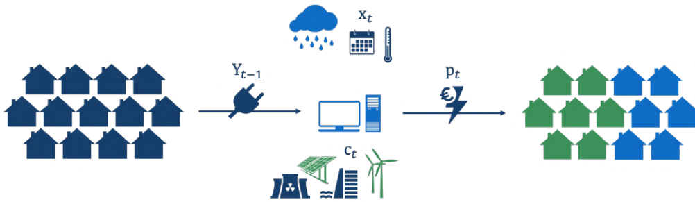
Figure 1.10 – Illustration d’une itération du protocole de pilotage de la demande électrique d’une population homogène. En entrée, l’algorithme reçoit les variables contextuelles x_t et une consommation cible c_t (la production d’électricité) et a observé la consommation au tour précédent Y_{t-1} . Il a aussi accès à l’historique (tours 1 à t-1 ) des consommations, des variables contextuelles et des tarifs choisis. Il choisit alors les proportions de la population à qui il envoie les différents tarifs. Sur cet exemple, il scinde la population en deux et envoie le tarif bleu à 6/13 de la population et le tarif vert au 7/13 restant.
