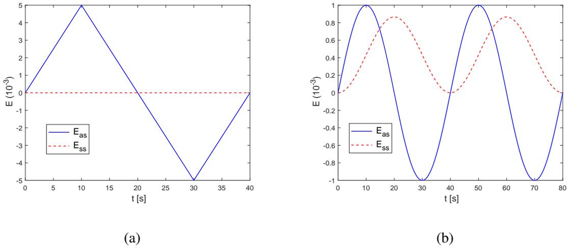
FIGURE 4.9: Histoires de chargements considérés : (a) programme 3 : déformation radiale consistant en un cisaillement axisymétrique cyclique, (b) programme 4 : chargement tournant.
