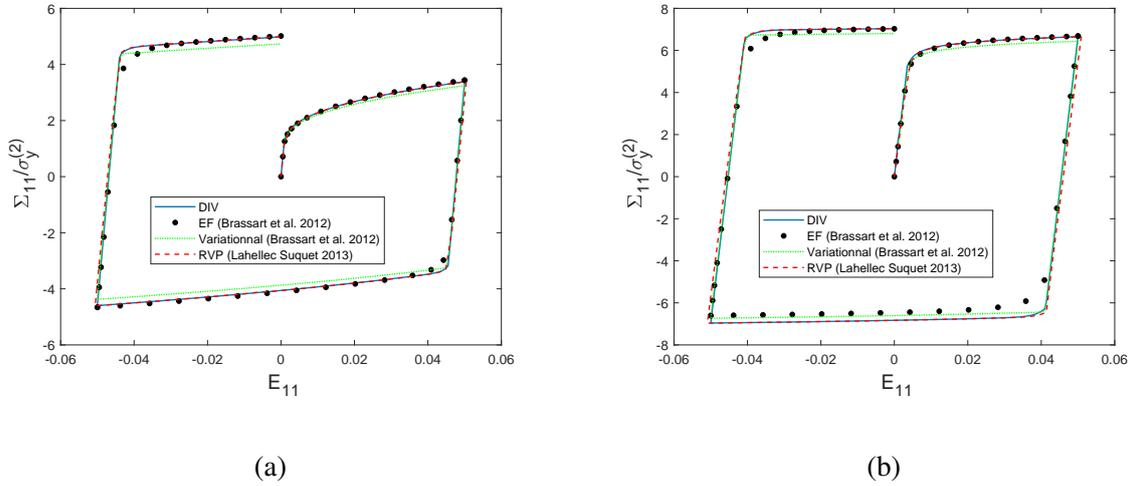
FIGURE 4.16: Composite renforcé à matrice métallique élasto-plastique avec de l'écroutissage isotrope soumis à une traction uni-axiale cyclique.  $c^{(1)} = 25\%$ . Evolution de la contrainte effective normalisée. (a)  $\gamma^{(2)} = 0.4$ , (b)  $\gamma^{(2)} = 0.05$ .
