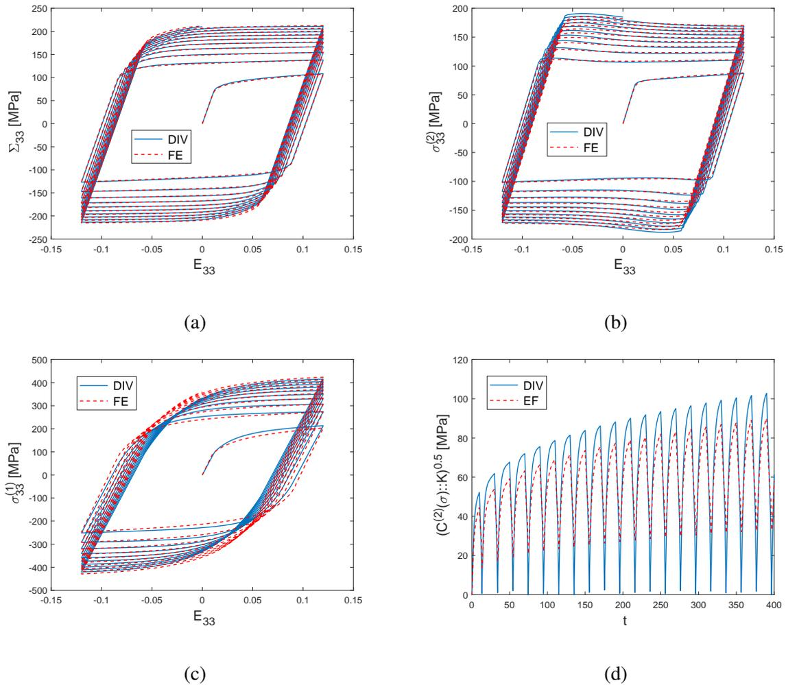
FIGURE 4.17: Composite renforcé élastiquement à matrice élasto-plastique avec de l'écroutissage isotrope soumis à un chargement radial de 10 cycles (Programme 1, Fig. 4.8)  $c^{(1)} = 0.17$ . (a) Contrainte macroscopique axiale, (b) Moyenne des contraintes axiales dans la matrice, (c) Moyenne des contraintes axiales dans l'inclusion, (d) Fluctuations des contraintes dans la matrice.
