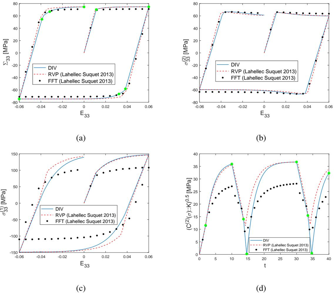
FIGURE 4.10: Composite composé d'une matrice parfaitement plastique renforcée élastiquement soumis à un chargement radial (programme 1, Fig 4.8).  $c^{(1)} = 0.17$ . (a) Contrainte macroscopique axiale, (b) Moyenne des contraintes axiales dans la matrice, (c) Moyenne des contraintes axiales dans l'inclusion, (d) Fluctuations des contraintes dans la matrice.
