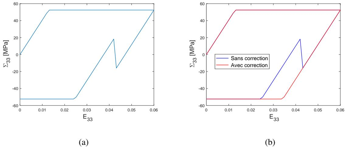
FIGURE 4.20: Matériau poreux à matrice élasto-plastique parfaitement plastique soumis à une extension isochore cyclique.  $c^{(1)} = 0.17$ . (a) Variation de la contrainte macroscopique axiale sans correction de l’algorithme, (b) Variation de la contrainte macroscopique axiale avec et sans correction de l’algorithme.
