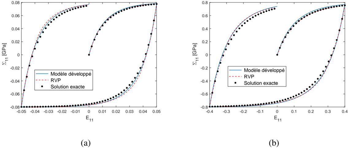
FIGURE 2.2: Composite à matrice visco-élastique linéaire de type Maxwell renforcée par des particules élastiques et soumis à une extension isochore macroscopique de la forme (2.92).  $c^{(1)} = 0.4$ . Réponse macroscopique pour (a)  $\eta^{(2)} = 3 \text{ GPa.s}$ , (b)  $\eta^{(2)} = 30 \text{ GPa.s}$ .
