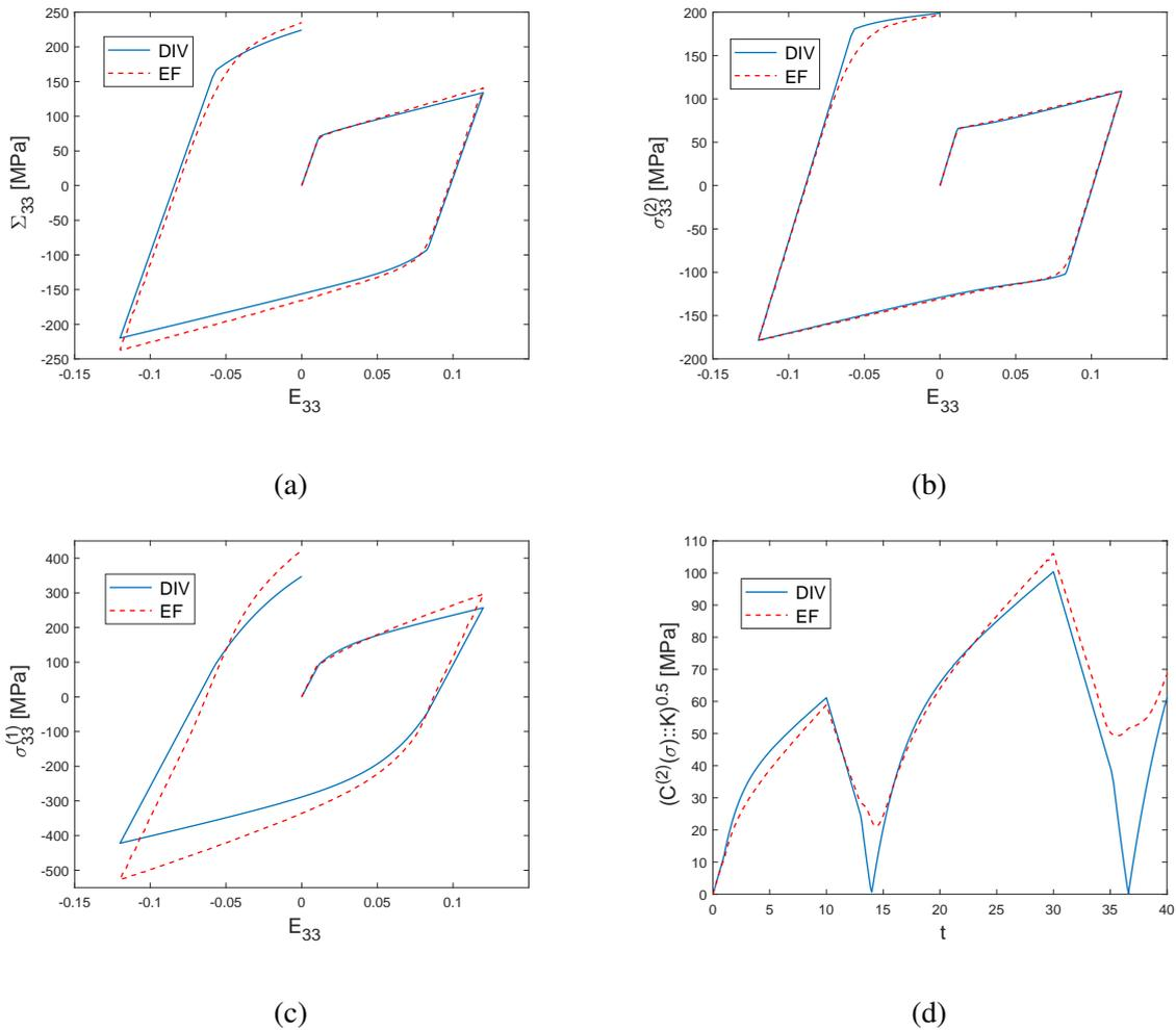
FIGURE 4.19: Composite renforcé élastiquement à matrice élasto-plastique avec des écrouissages cinématique linéaire et isotrope combinés.  $c^{(1)} = 0.17$ . Extension macroscopique isochore (programme 1, Fig 4.8). (a) Contrainte macroscopique axiale, (b) Moyenne des contraintes axiales dans la matrice, (c) Moyenne des contraintes axiales dans l'inclusion, (d) Fluctuations des contraintes dans la matrice.
