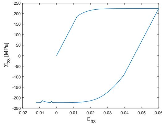
FIGURE 7.2: Composite à matrice parfaitement plastique de type Green renforcée élastiquement soumis à une extension uni-axiale cyclique.  $c^{(1)} = 0.17$ . Evolution de la contrainte macroscopique axiale sans choisir la racine appropriée.
