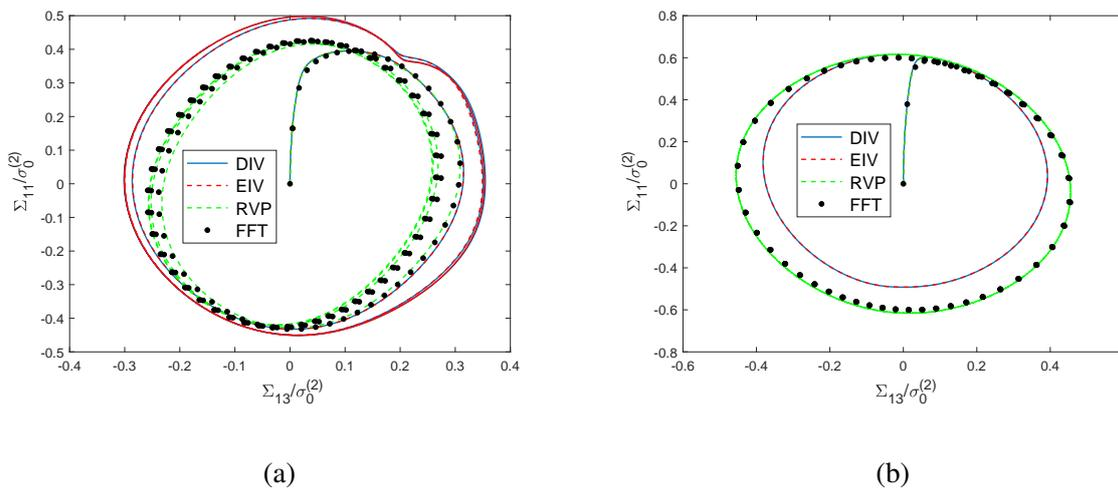
FIGURE 4.25: Composite incompressible renforcé à matrice élasto-viscoplastique sans seuil ( $m = 0.2$ ), pour différents contrastes élastiques, soumis à un chargement tournant (cf. (4.5) et (4.7)).  $c^{(1)} = 0.3$ . (a) Contraste élastique  $R = 0.2$ , (b) Contraste élastique  $R = 5$ .
