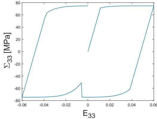
FIGURE 4.2: Composite à matrice parfaitement plastique renforcée élastiquement soumis à une extension isochore cyclique.  $c^{(1)} = 0.17$ . Evolution de la contrainte macroscopique axiale sans choisir la racine appropriée.
