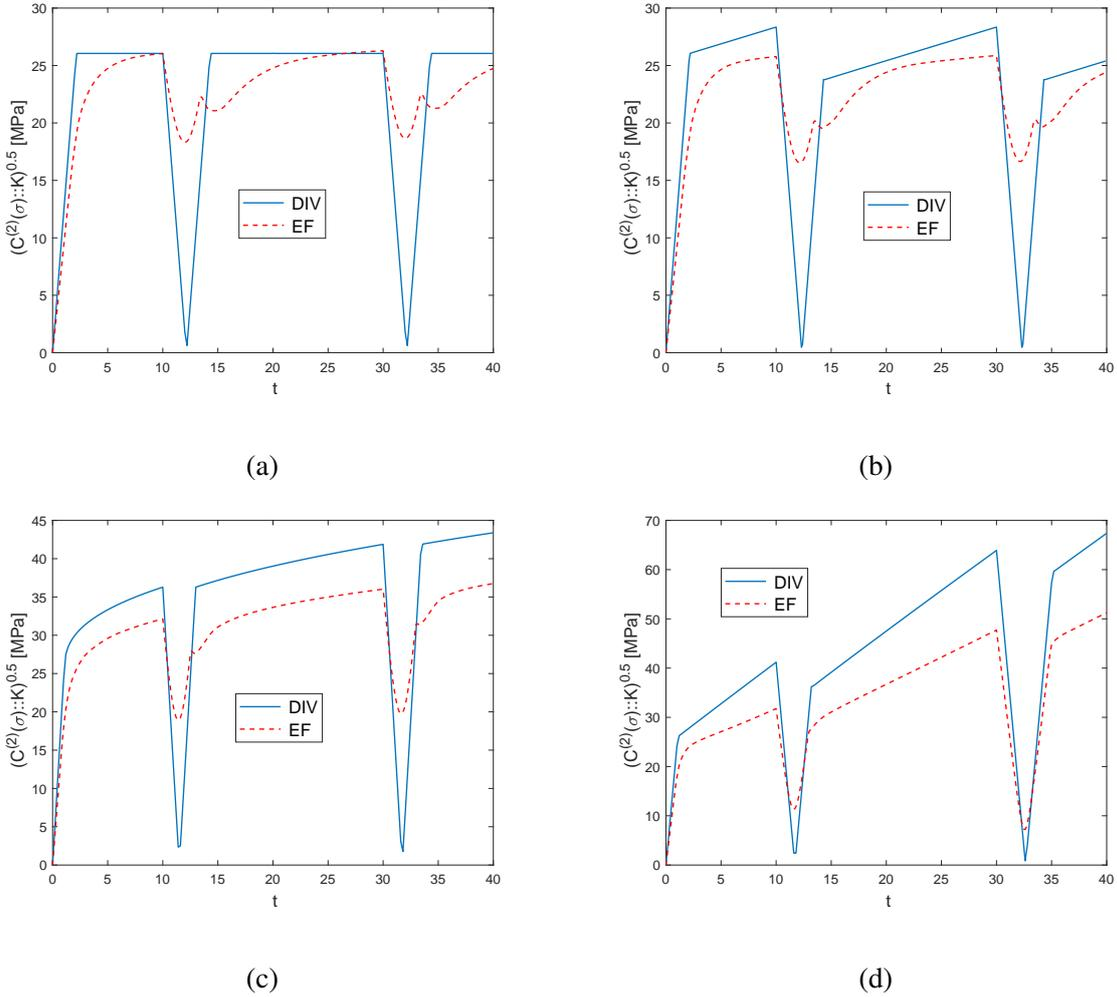
FIGURE 4.22: Matériaux poreux constitué d'une matrice élasto-plastique soumis à une extension macroscopique isochore cyclique (programme 1, Fig 4.8).  $c^{(1)} = 0.17$ . Fluctuations des contraintes dans la matrice pour une (a) Matrice parfaitement plastique, (b) Matrice avec de l'écroutissage cinématique linéaire, (c) Matrice avec de l'écroutissage isotrope, (d) Matrice avec des écroutissages cinématique linéaire et isotrope combinés.
