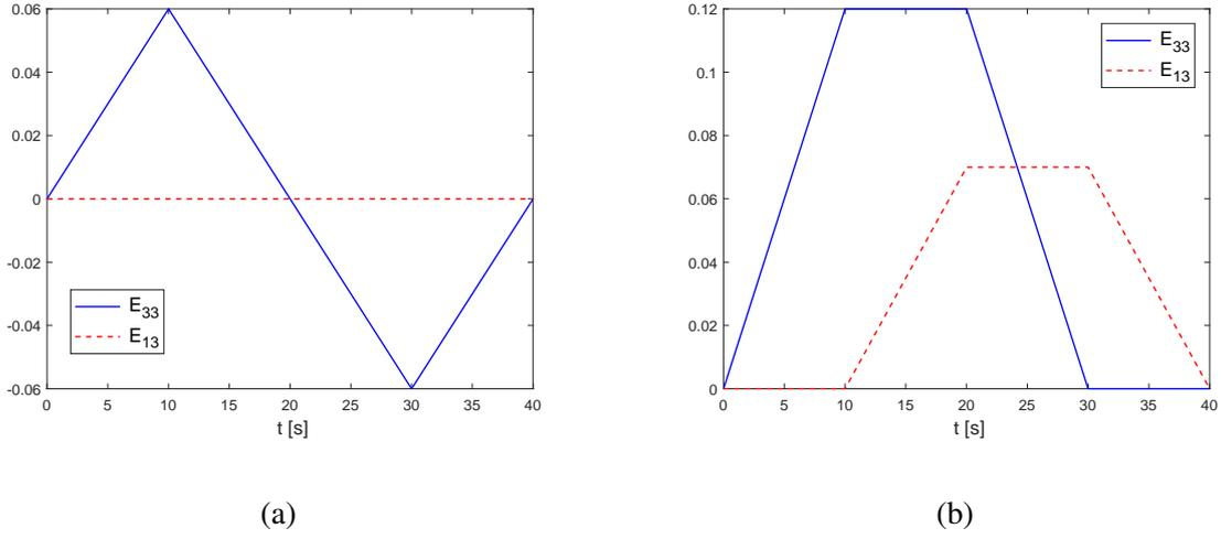
FIGURE 4.8: Deux différentes histoires de chargements : déformation macroscopique axiale  $E_{33}(t)$ , déformation macroscopique de cisaillement  $E_{13}(t)$ , (a) programme 1 : chargement radial, (b) programme 2 : chargement non radial.
