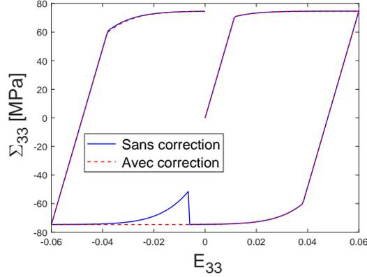
FIGURE 4.4: Composite à matrice parfaitement plastique renforcée élastiquement soumis à une extension isochore cyclique.  $c^{(1)} = 0.17$ . Variation de la contrainte axiale macroscopique avec et sans la correction de l'algorithme.
