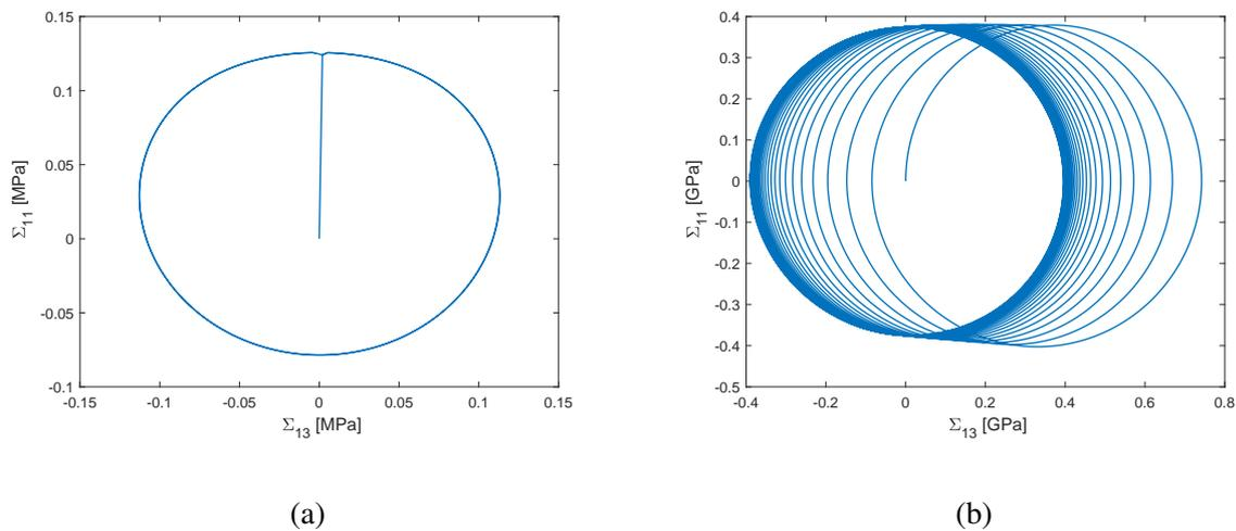
FIGURE 2.4: Composite à matrice visco-élastique linéaire de type Maxwell renforcée élastiquement et soumis à un chargement tournant de la forme (2.93), (2.94).  $c^{(1)} = 0.4$ . Réponse macroscopique pour (a)  $\eta^{(2)} = 3 \text{ MPa.s}$ , (b)  $\eta^{(2)} = 300 \text{ GPa.s}$ .
