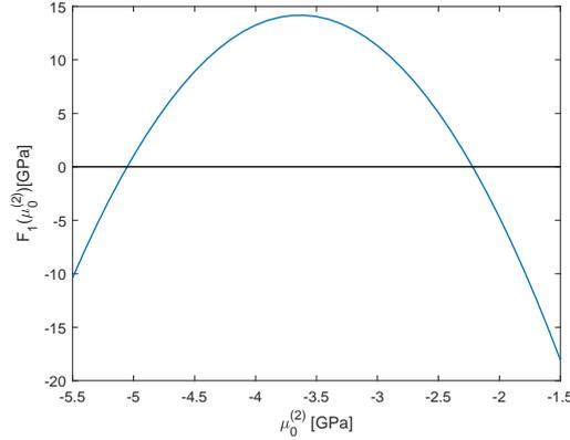
FIGURE 4.3: Composite à matrice parfaitement plastique renforcée élastiquement soumis à une extension isochore cyclique.  $c^{(1)} = 0.17$ . Variation de la fonction  $F_1$  en fonction de  $\mu_0^{(2)}$  au point correspondant au saut observé sur la figure 4.2.
