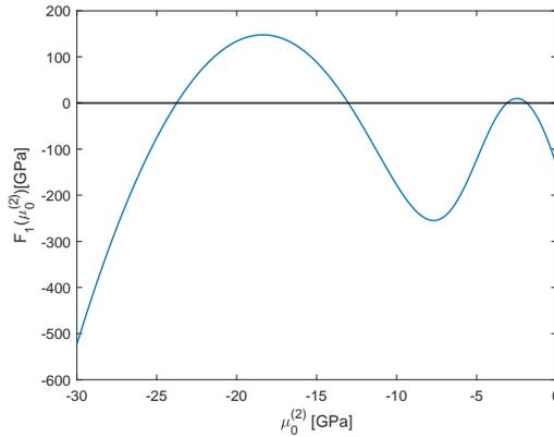
FIGURE 4.5: Composite à matrice parfaitement plastique renforcée élastiquement soumis à une extension isochore cyclique.  $c^{(1)} = 0.17$ . Variation de la fonction  $F_1$  en fonction de  $\mu_0^{(2)}$  pour  $\eta_{\varepsilon^p}^{(2)}$  fixé au temps  $t = 20s$ .
