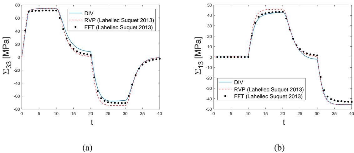
FIGURE 4.13: Composite renforcé élastiquement à matrice parfaitement plastique soumis à un chargement radial (Programme 2, Fig 4.8).  $c^{(1)} = 0.17$ ,  $E^{(1)}/E^{(2)} = 2$ . (a) Contrainte macroscopique axiale, (b) Contrainte macroscopique de cisaillement.
