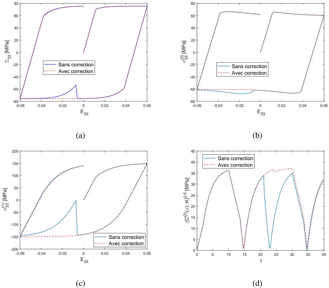
FIGURE 6.1: Composite renforcé élastiquement à matrice élasto-plastique avec de l'écroutissage cinématique non linéaire soumis à une extension isochore cyclique.  $c^{(1)} = 0.17$ . (a) Contrainte macroscopique axiale, (b) Moyenne des contraintes axiales dans la matrice, (c) Moyenne des contraintes axiales dans l'inclusion, (d) Fluctuations des contraintes dans la matrice.
