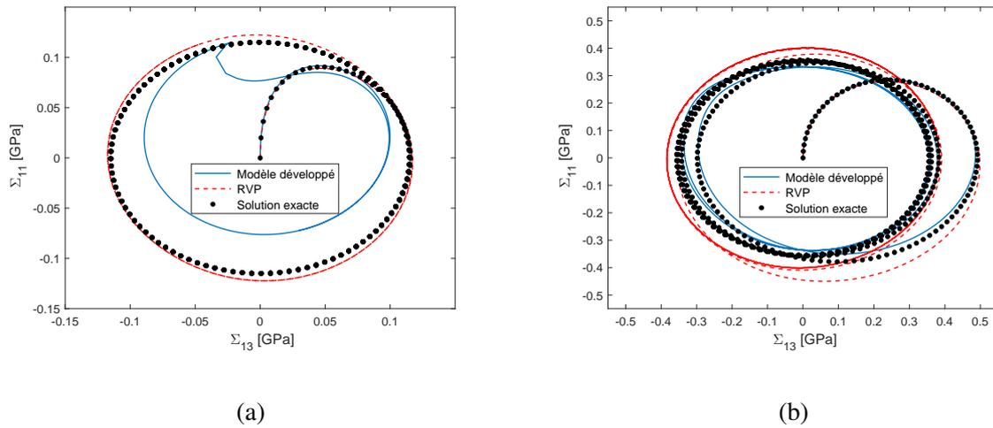
FIGURE 2.3: Composite à matrice visco-élastique linéaire de type Maxwell renforcée élastiquement et soumis à un chargement tournant de la forme (2.93), (2.94).  $c^{(1)} = 0.4$ . Réponse macroscopique pour (a)  $\eta^{(2)} = 3 \text{ GPa.s}$ , (b)  $\eta^{(2)} = 30 \text{ GPa.s}$ .
