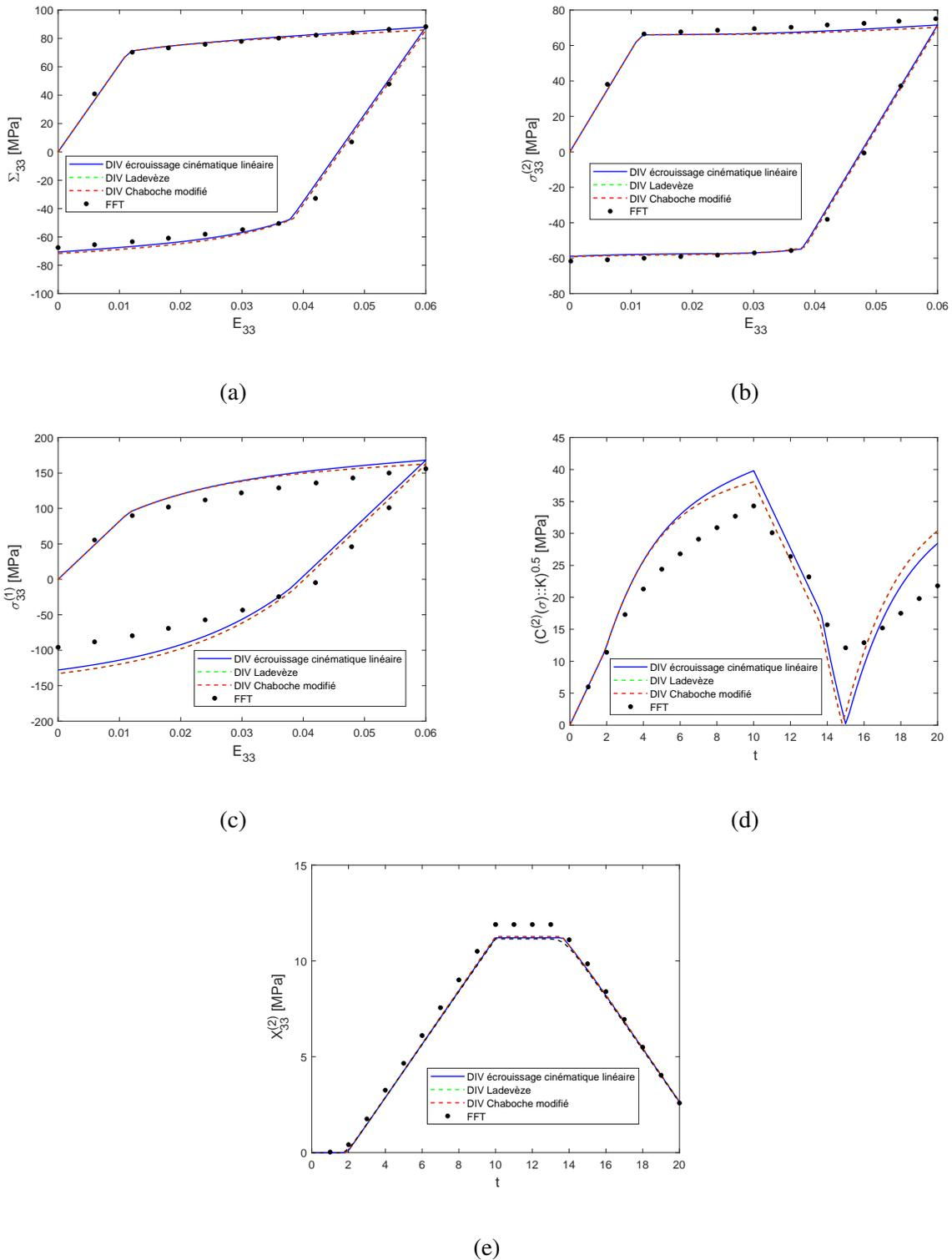
FIGURE 6.8: Composite constitué d'une matrice élasto-plastique avec de l'érouissage cinématique non linéaire ( $a^{(2)} = 300$  MPa, et  $\gamma^{(2)} = 0.1$ ) renforcée élastiquement et soumis à une extension macroscopique isochore cyclique.  $c^{(1)} = 0.17$ . (a) Contrainte axiale macroscopique, (b) Moyenne des contraintes dans la matrice, (c) Moyenne des contraintes dans l'inclusion, (d) Fluctuations des contraintes dans la matrice, (e) Moyenne de la contrainte de rappel dans la matrice.
