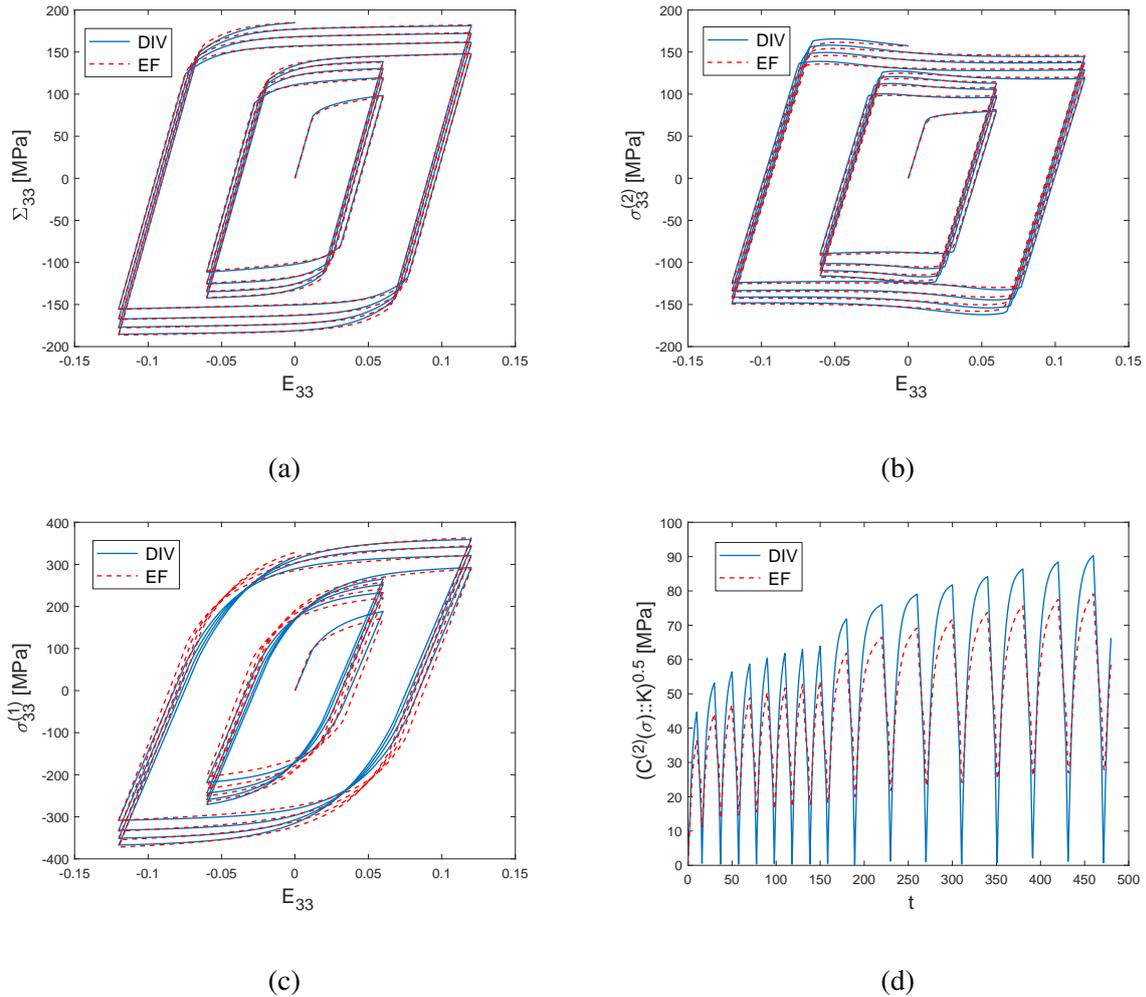
FIGURE 4.18: Composite renforcé élastiquement à matrice élasto-plastique avec de l'écroutissage isotrope soumis à un chargement radial de 8 cycles (Programme 1, Fig. 4.8)  $c^{(1)} = 0.17$ . (a) Contrainte macroscopique axiale, (b) Moyenne des contraintes axiales dans la matrice, (c) Moyenne des contraintes axiales dans l'inclusion, (d) Fluctuations des contraintes dans la matrice.
