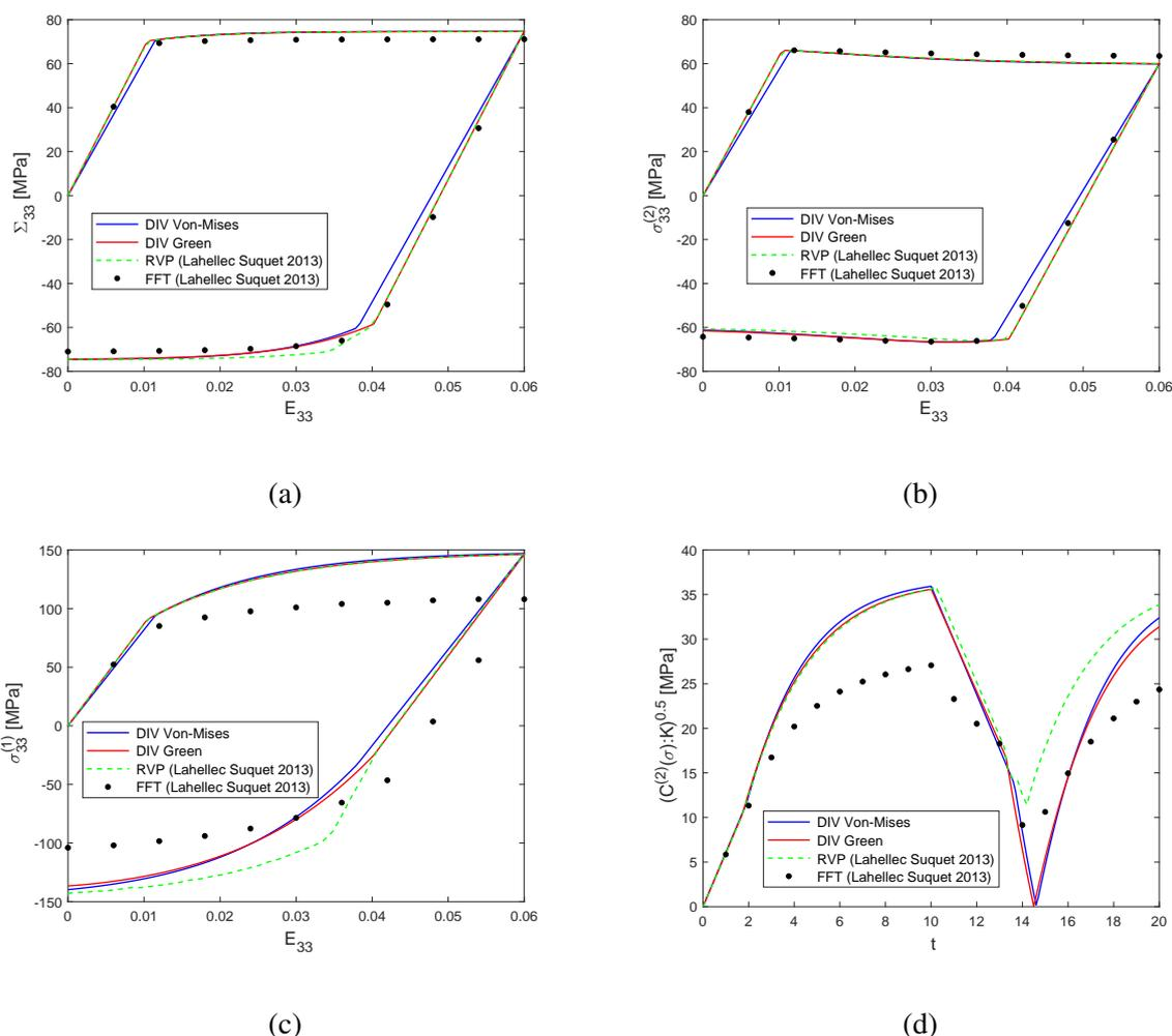
FIGURE 7.5: Composite composé d'une matrice de type Green renforcée élastiquement soumis à un chargement radial (programme 1, Fig 4.8).  $c^{(1)} = 0.17$ . (a) Contrainte macroscopique axiale, (b) Moyenne des contraintes axiales dans la matrice, (c) Moyenne des contraintes axiales dans l'inclusion, (d) Fluctuations des contraintes dans la matrice.
