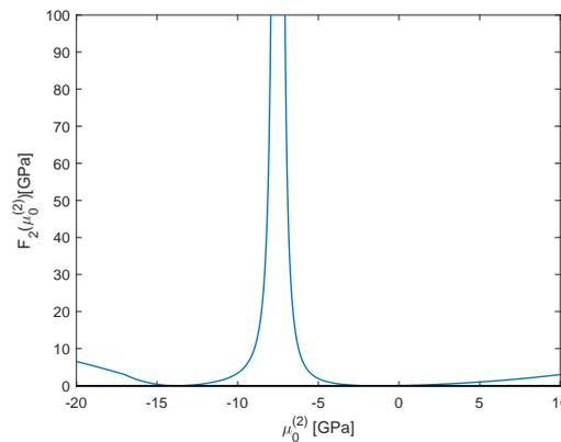
FIGURE 4.6: Composite à matrice parfaitement plastique renforcée élastiquement soumis à une extension isochore cyclique.  $c^{(1)} = 0.17$ . Variation de la fonction  $F_2$  en fonction de  $\mu_0^{(2)}$  pour  $\eta_{\varepsilon^p}^{(2)}$  fixé au temps  $t = 20s$ .
