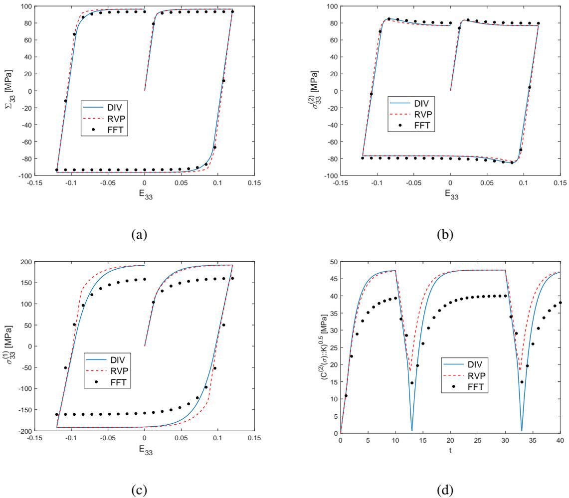
FIGURE 4.27: Composite renforcé à matrice élasto-viscoplastique avec seuil soumis à une extension isochore cyclique (programme 1, Fig 4.8) pour une vitesse de  $12 \cdot 10^{-2} \text{ s}^{-1}$ .  $c^{(1)} = 0.17$ . (a) Contrainte axiale macroscopique, (b) Moyenne de la contrainte axiale dans la matrice, (c) Moyenne de la contrainte axiale dans l'inclusion, (d) Fluctuations des contraintes dans la matrice.
