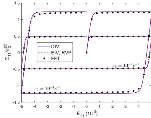
FIGURE 4.24: Comportement effectif d'un composite élastiquement incompressible à matrice élasto-viscoplastique sans seuil ( $m = 0.2$ ) renforcée élastiquement ( $c^{(1)} = 0.3$ ) pour un contraste élastique de  $R = 5$ , soumis à un chargement de cisaillement axisymétrique (Eqs. (4.5) et (4.6), programme 3, Fig. 4.9a) pour  $\dot{\varepsilon}_0 = 10^{-2} \text{ s}^{-1}$  et  $\dot{\varepsilon}_0 = 10^{-4} \text{ s}^{-1}$ .
