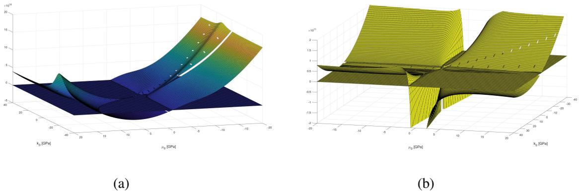
FIGURE 7.3: Variation des fonctions du système non linéaire (7.49) en fonction des variables  $k_0^{(2)}$  et  $\mu_0^{(2)}$  pour une valeur de  $\eta_{\varepsilon^p}^{(2)}$  fixée : (a) Variation de la fonction  $F_1$ , (b) Variation de la fonction  $F_2$ .
