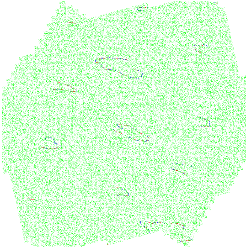
figure 4.17 : Volume de simulation du coefficient 2 « déplié » suivant le plan de glissement du système mobile (segments en bleu) de normale (\bar{1}\bar{4}8) . Les points verts représentent les dislocations obstacles qui traversent le plan de glissement et les jonctions sont tracées en rouge. Les points d'ancrage des sources sont éloignés de 10\ \mu\text{m} ce qui permet de juger de l'efficacité de l'optimisation. Le côté du volume déplié est d'environ 250\ \mu\text{m} de côté.
