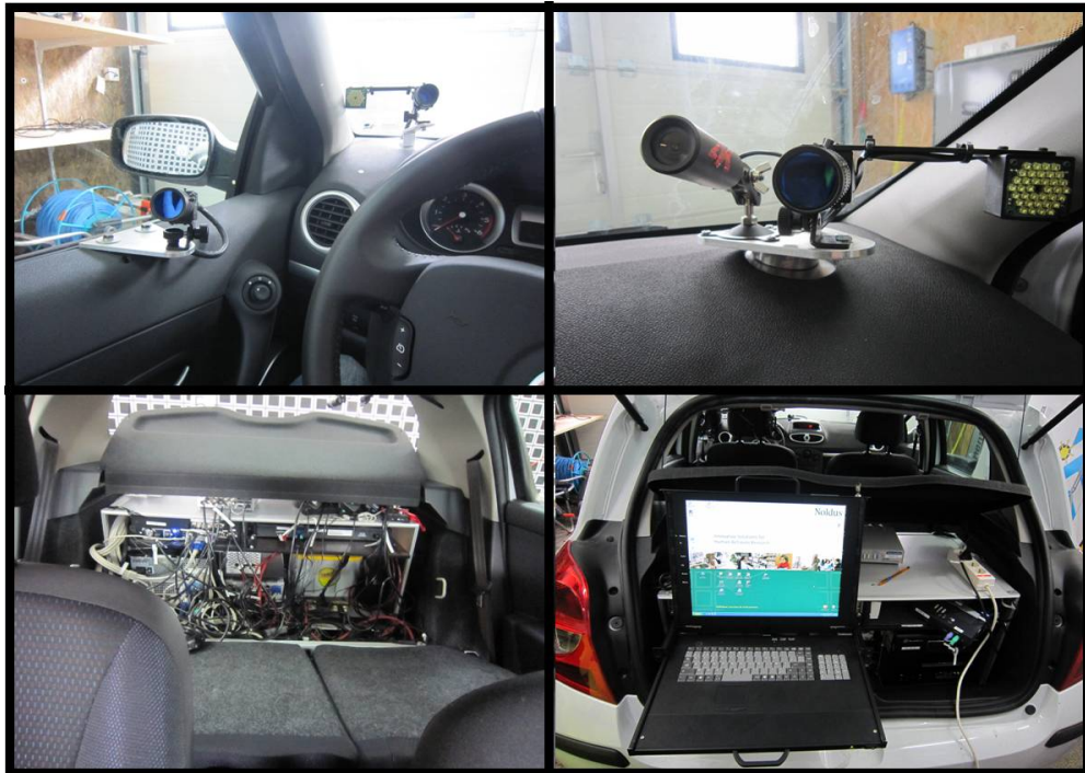
Figure 5.3.: Photos de l'intérieur du véhicule instrumenté : en haut à gauche, les deux caméras de gauche filmant la tête ; en haut à droite, la caméra de droite filmant la tête, avec une lampe infra-rouge, et une caméra filmant l'intérieur de la cabine ; en bas, deux vues de l'intérieur de coffre avec les ordinateurs gérant l'ensemble du dispositif d'enregistrement des données comportementales.
