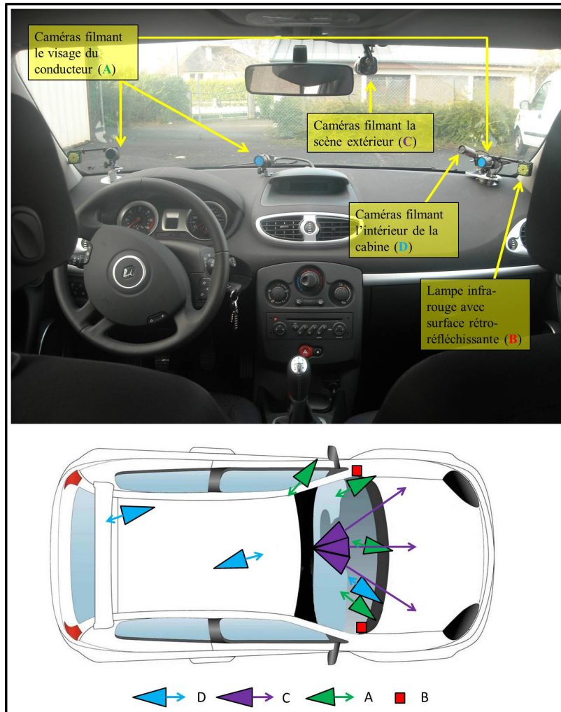
Figure 5.1.: En haut, une photographie de l'intérieur du véhicule instrumenté, en bas, un schéma vu de dessus de ce même véhicule (adapté de Désiré (2010)). L'emplacement d'une partie du matériel lié à l'oculomètre est indiqué, à savoir les caméras filmant le visage des participants (A), des lampes infra-rouge et surfaces rétro-réfléchissantes (B), et des caméras filmant l'extérieur du véhicule (C - sur la photo, une seule caméra est représentée, cette caméra a été remplacée par un trépied de 3 caméras comme indiqué sur le schéma afin de couvrir une plus grande surface du champ visuel). La position des caméras permettant de filmer l'intérieur de la cabine, ainsi que l'environnement extérieur à l'arrière, est également indiqué (D). La Figure 5.3 permet d'avoir une vue plus détaillée de ces caméras.
