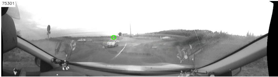
Figure 5.2.: Exemple d'une image extraite d'un panorama construit lors de l'approche d'un des carrefours de l'étude à partir des trois caméras de scène. Le disque vert indique la position du regard.
