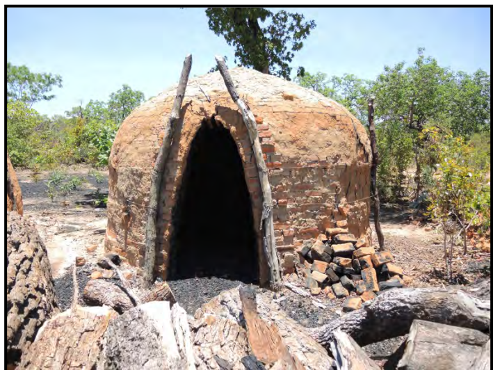
Photo 14 : Fours artisanaux du nord du Minas Gerais permettant la fabrication de charbon de bois par pyrolyse des arbres du cerrado
