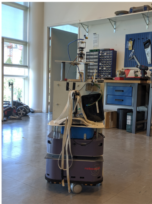
FIGURE 5.8 – Un robot Robulab du laboratoire ETIS sur lequel est implémenté le modèle PerAc.
