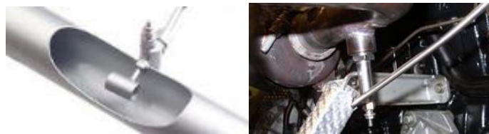
Figure 3-19 : Vue d'un vaporiseur de gazole 102 et d'une implantation sur notre banc d'essai 86
