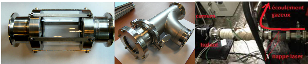
Figure 5-3 : Photos des accès optiques pour mesure dans un plan perpendiculaire à l'axe de l'écoulement, et photo de l'installation au banc moteur
