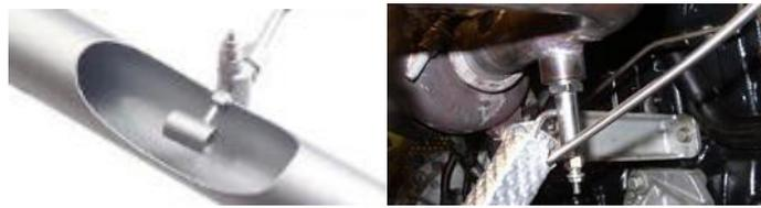
Figure 3-19 : Vue d'un vaporiseur de gazole<sup>102</sup> et d'une implantation sur notre banc d'essai<sup>86</sup>
