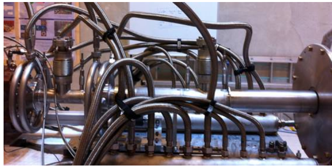
Figure 92 : Conduite mobile (trombone) placée à l'aval de la chambre de combustion et raccordée au tube d'échappement.
