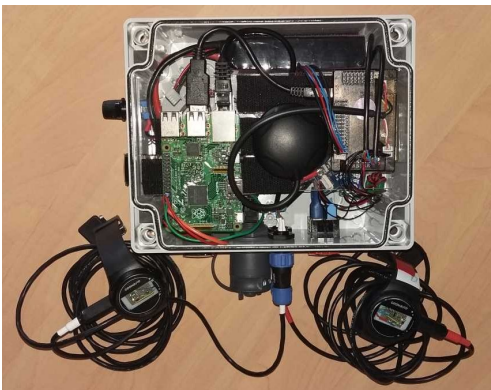
FIGURE 5.2 – Boîtier étanche du GSN et bracelets vibrants.
