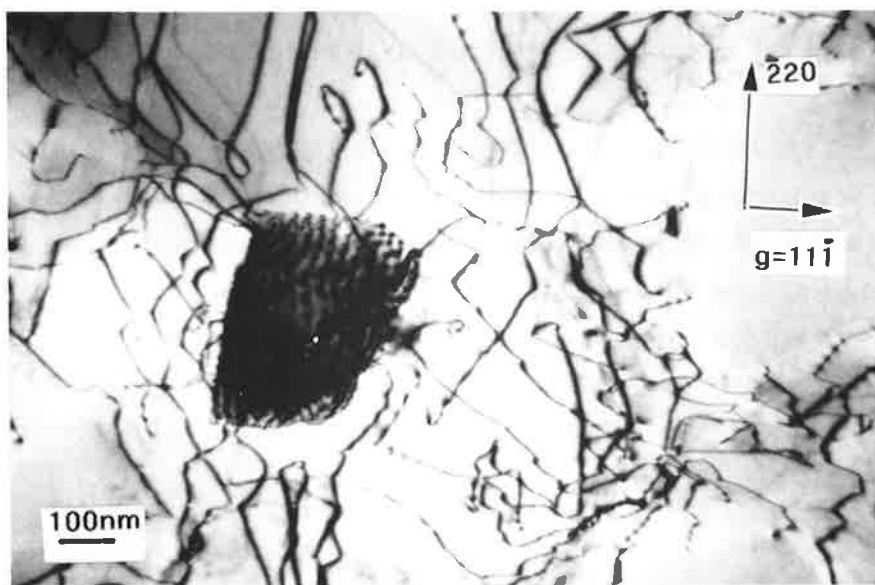
Figure V.35 : Certaines zones ont une déformation uniformément répartie dans les trois couloirs. Axe de zone = \langle 121 \rangle
