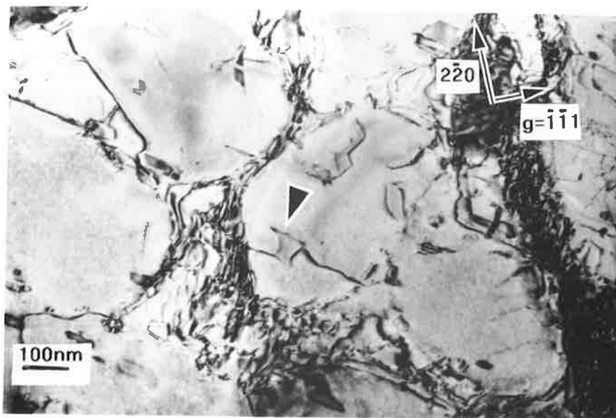
Figure V.54 : Image en champ clair donnant les signes des dislocations et par la suite avec la règle exposée au chapitre I la nature du défaut de surstructure, ici il est extrinsèque. On note le contraste double de a. Axe de zone - \langle 112 \rangle
