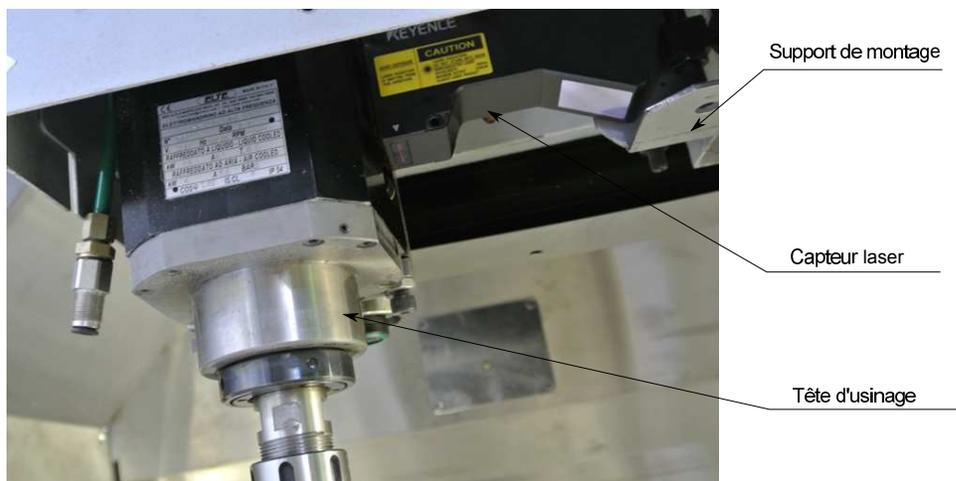
FIGURE 2.51 – Vue du montage du capteur laser sur la tête d'usinage
