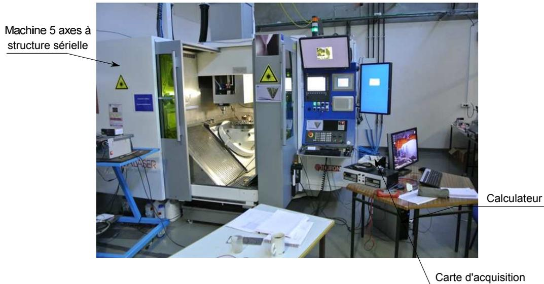
FIGURE 2.50 – Vue d'ensemble du dispositif expérimental
