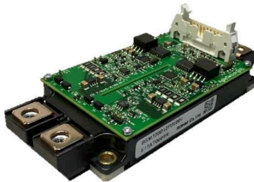
Figure I-16 : Assemblage d'un module SiC Econo-Dual avec sa carte driver EDEM34 4
