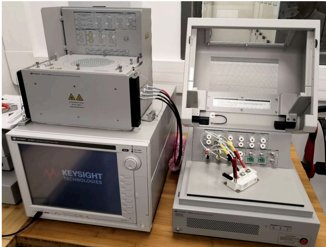
Figure II-14 : Caractérisation d'un module SiC au traceur B1505A (Power Device Analyzer)
