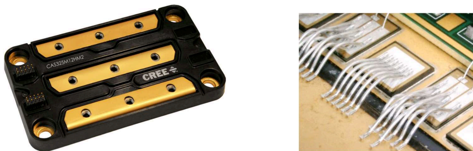
Figure I-14 : Module de puissance MOSFET SiC 1200V CAS325M12HM2 (Wolfspeed-Cree) 3
