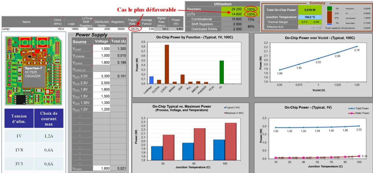
Figure IV-1 : Simulation de la puissance maximale consommée par le FPGA (Spartan-7) - outil XPE de Xilinx
