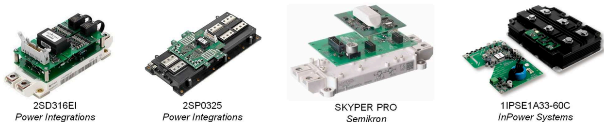
Figure I-42 : Assemblage des cartes driver au plus proche des modules de puissance
