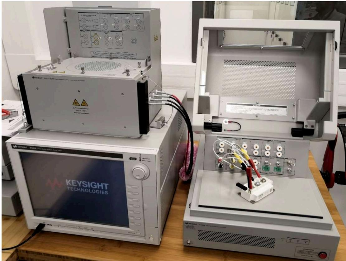
Figure II-14 : Caractérisation d'un module SiC au traceur B1505A (Power Device Analyzer)
