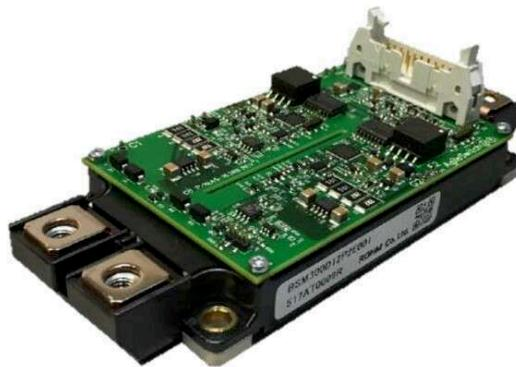
Figure I-16 : Assemblage d'un module SiC Econo-Dual avec sa carte driver EDEM34<sup>4</sup>
