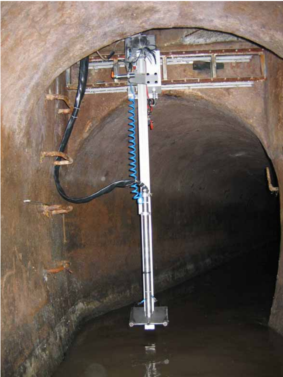
Figure 44: Echantillonneur 2D « Hydre » pour l'étude simultanée les champs de vitesses et de concentrations.
