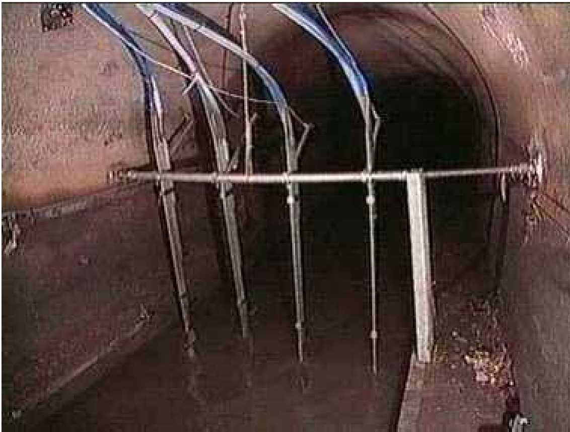
Figure 33: Echantillonneur 2D « Orphée » pour les mesures des concentrations.
