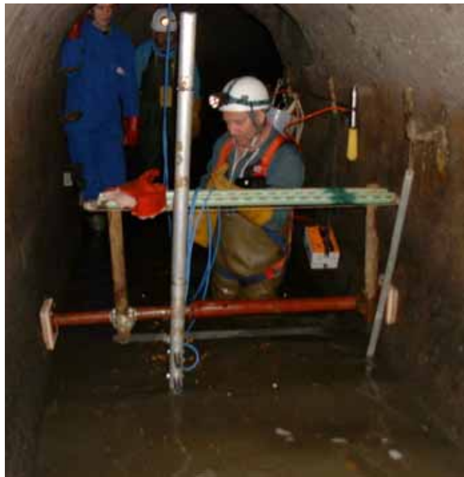
Figure 11: Echantillonneur 2D « Cerbères light » pour les vitesses au Jardin des Plantes.
