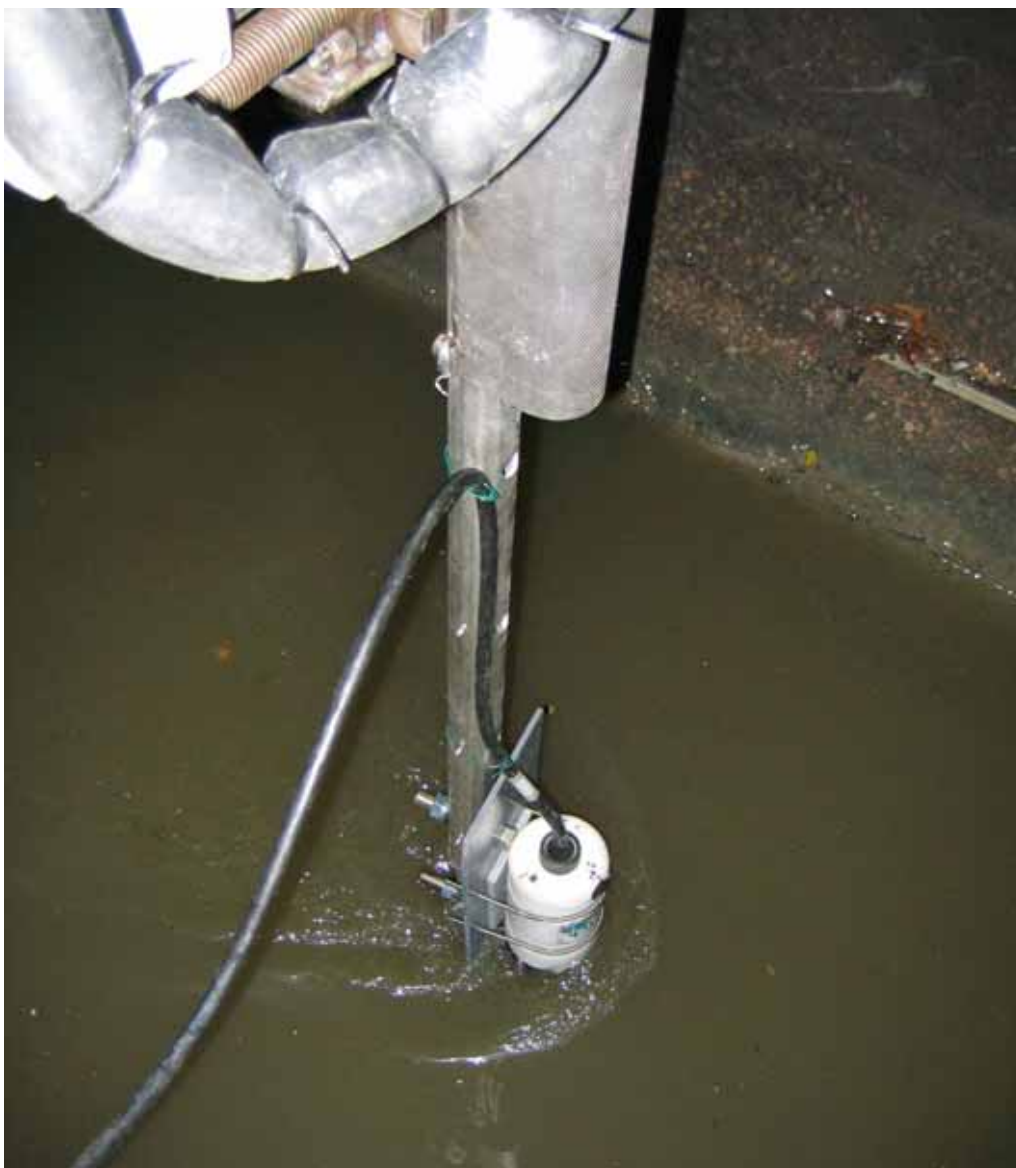
Figure 45: Premiers essais de porte-instruments : profileur de vitesse sur « Cerbères »
