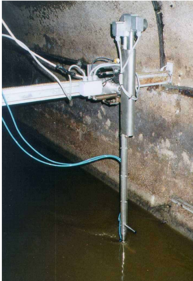
Figure 10: Echantillonneur 2D « Cerbères » pour les vitesses à Cordon Bleu.
