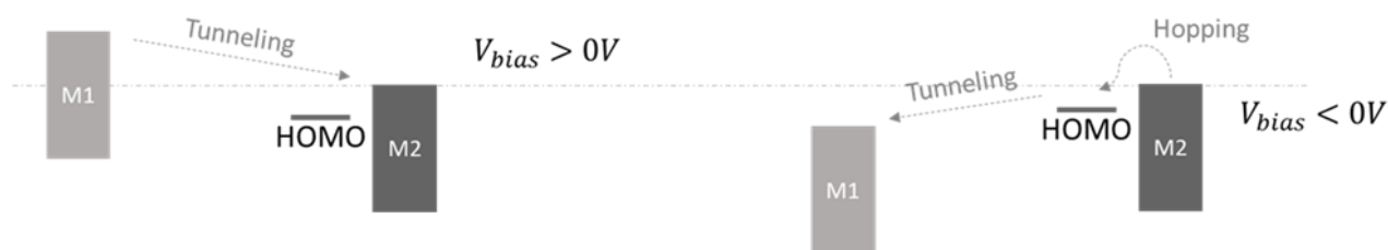
Figure 18: Situation de la diode entre deux électrodes lorsque le biais est positif (situation de gauche), dans ce cas la diode est bloquante. Situation de la diode entre deux électrodes quand le biais est négatif (à droite) dans ce cas la diode est passante. [61]
