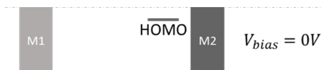
Figure 17: Situation "au repos" de la diode moléculaire entre deux électrodes à biais nul. [61]
