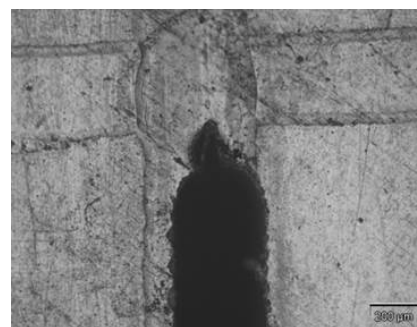
(b) Fond d'entaille sur éprouvette CT
