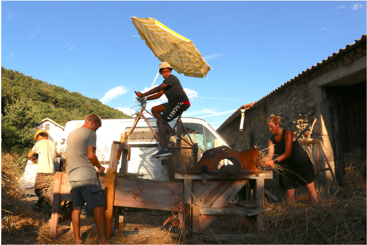
Image 22 : Batteuse permettant de séparer les grains de blé de leur tige. Sur base de la récupération de pièces originales, celle-ci a cependant été bricolée de manière à remplacer le moteur par un vélo qui produit la force nécessaire pour faire mouvoir le cylindre tournant.
