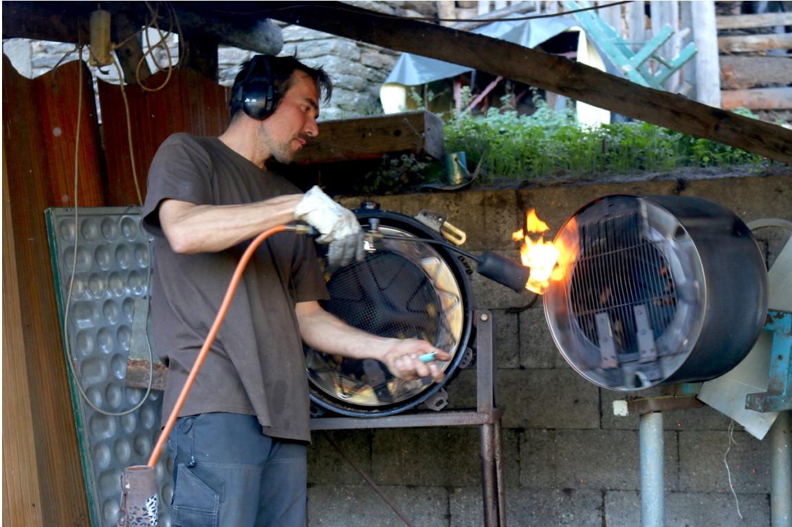
Image 12 : Grillage des châtaignes visant à les débarrasser de la fine peau qui les recouvre. Ici, les habitants ont bricolé un tambour de machine à laver qui permet de garder les châtaignes en mouvement pour éviter qu'elles ne brûlent sous l'action du chalumeau.
