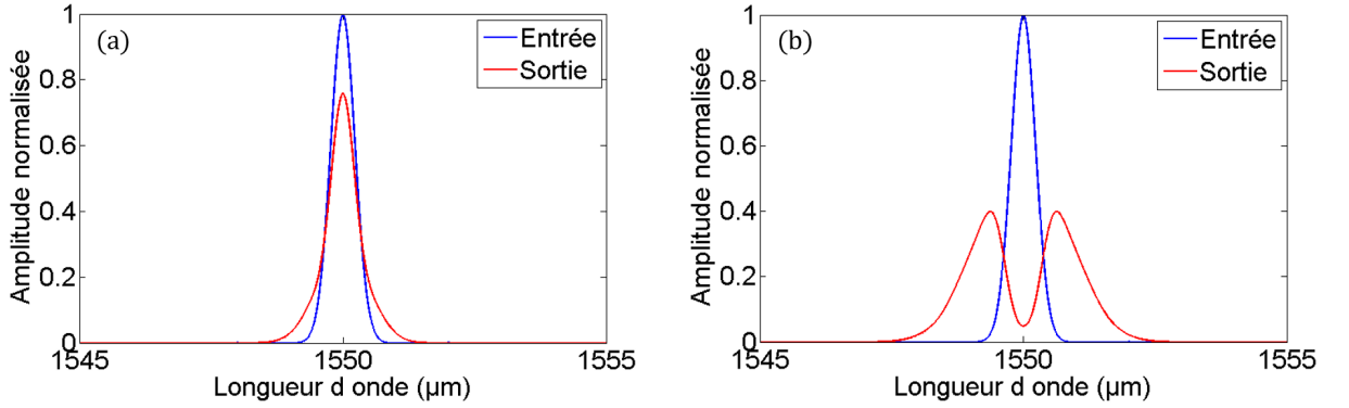
FIGURE 2.3 – Exemples d'élargissement du spectre induit par SPM ayant un déphasage maximal de (a) 0,5\pi et (b) 1,5\pi
