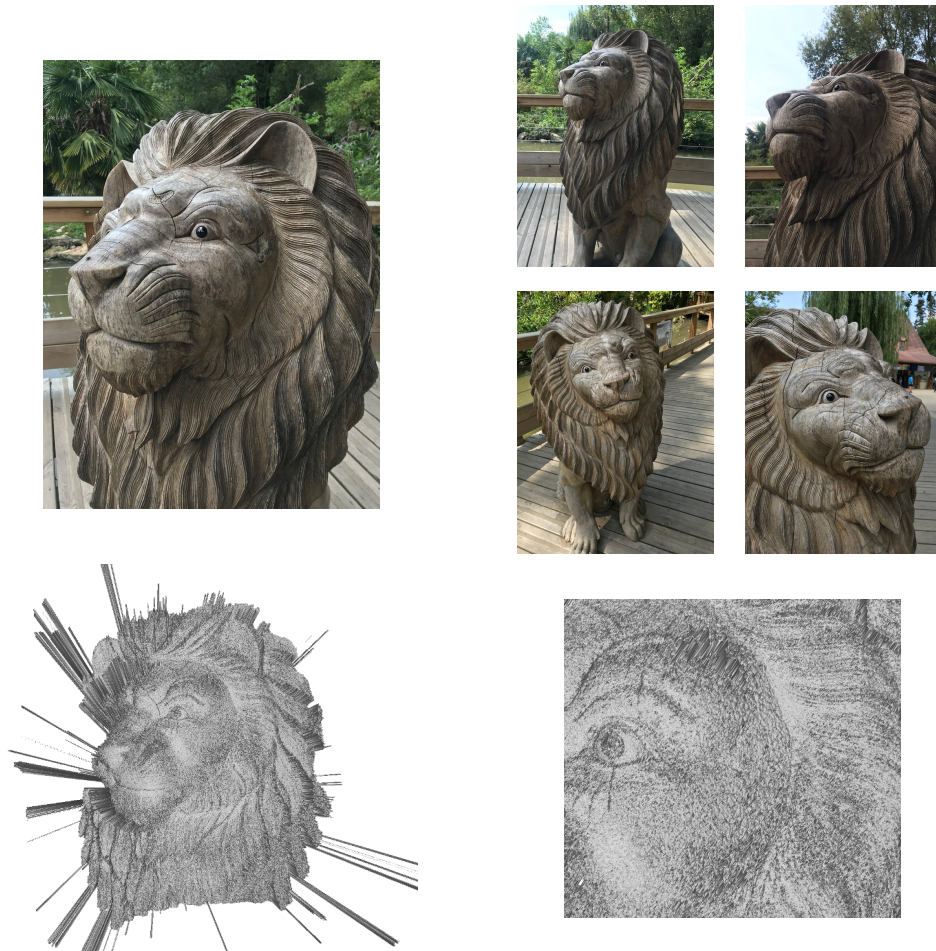
FIGURE 1.5 – Reconstruction 3D par MVS d’une scène fortement texturée. En haut à gauche : image de référence. En haut à droite : quatre images témoins (parmi 77). En bas à gauche : fonction de profondeur correspondant à l’image de référence, obtenue avec la suite logicielle AliceVision [7] par optimisation de la cohérence photométrique. Bien que cette fonction comporte quelques artéfacts, certains détails géométriques très fins sont effectivement retrouvés, comme le montre l’agrandissement en bas à droite.
