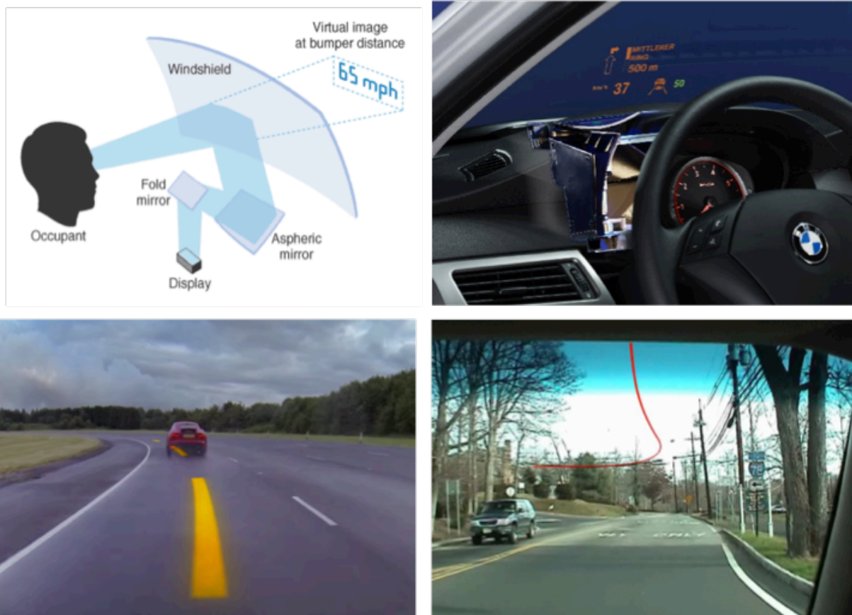
Figure 24 : Les afficheurs tête-haute ou HUD : A. Principe de conception, B. Exemple d'afficheur de petite taille tel que ceux commercialisés actuellement, C et D. Deux exemples de prototypes grand angle utilisés comme assistance au guidage du véhicule.
