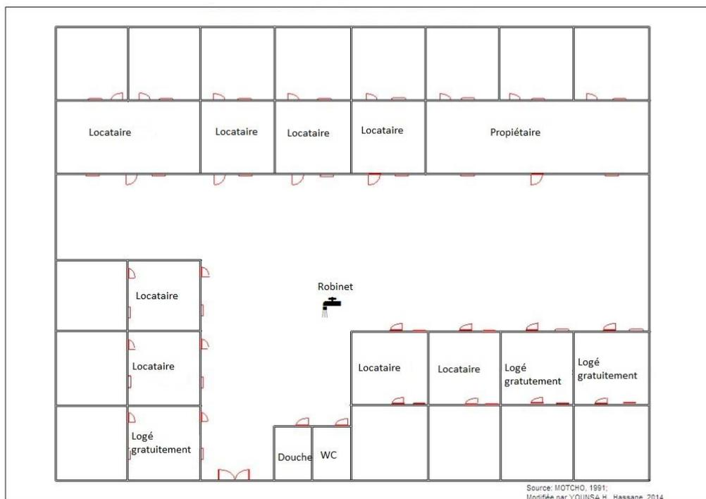
**Figure n° 13 : Plan d'une cour commune en banco qui donne accès à l'eau du réseau, grâce à un seul compteur d'eau (robinet).**
