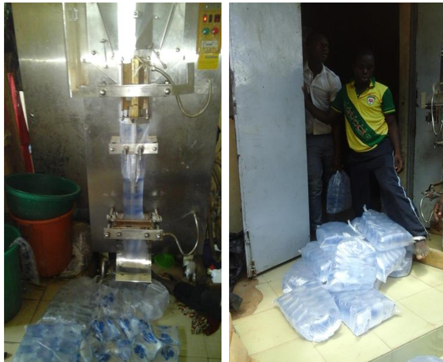
Photo n° 17 : a) Machine en fonction pour la fabrication pure water , b) des ouvriers faisant sortir les packs de pure water emballés et prêts pour la distribution devant l'usine.
