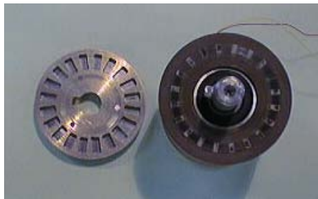
FIG. 3.28 – Usure de la surface de roulement, visible au dépôt noir de poussières de bakélite
