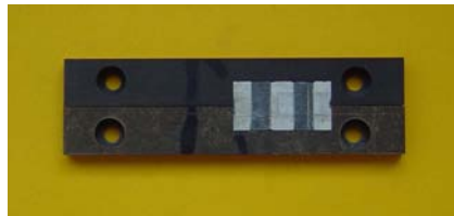
FIG. 3.20 – Photo du barreau de section 1\text{cm} \times 2\text{cm} avec métallisation sectorisée
