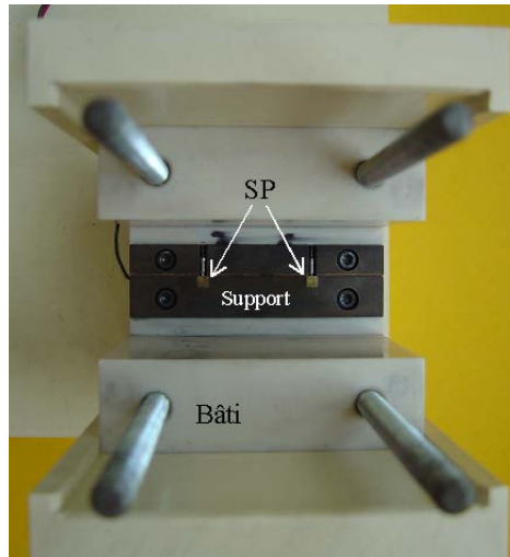
FIG. 3.6 – Supports amovibles pour diverses géométries de barreaux piézoélectriques
