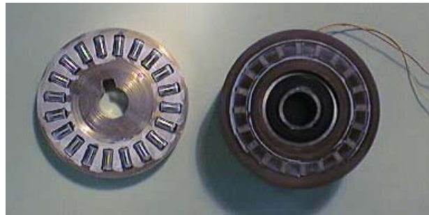
FIG. 3.32 – Etat de la surface de roulement après fonctionnement du DMA avec graisse silicone
