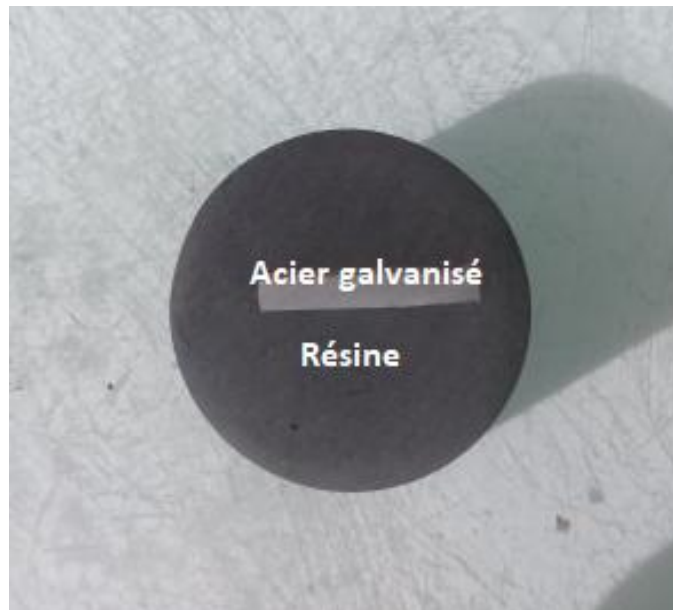
Figure 11: Une coupe transversale de l'acier galvanisé enrobée avec de la résine STRUERS-POLYFAST.
