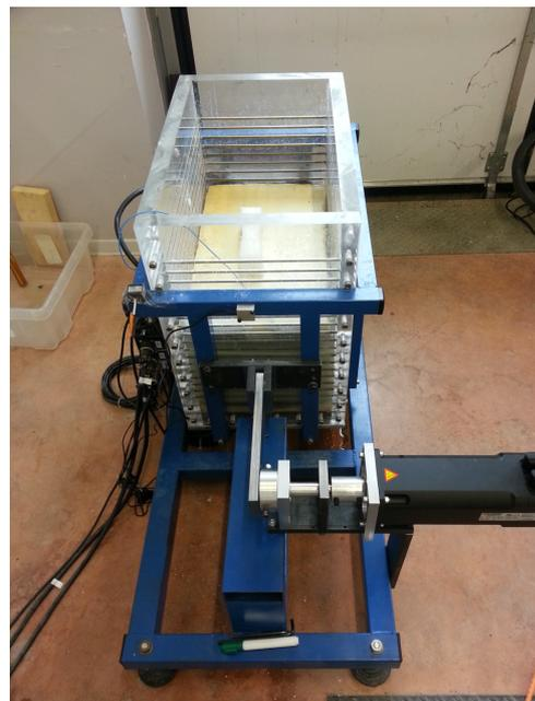
Figure 3.3 – Photographies des dispositifs expérimentaux à échelle réduite pour l'étude du renforcement des sols par a) colonnes ballastées et b) poudrettes de caoutchouc.
