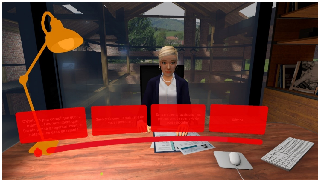
Figure 57 : Carte d'application de la disparité rétienne calculée. En rouge, les boîtes de dialogues sont les images les plus proches du système visuel en parallaxe négative. En orange, la lampe est moins proche du système visuel en parallaxe négative. Ces objets « sortes de l'écran. »
