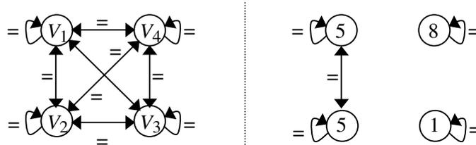
**Fig. 2.** Graphe initial associé à la contrainte  $nvalue(N, [V_1, V_2, V_3, V_4])$  et graphe final associé à l'instanciation  $nvalue(3, [5, 5, 1, 8])$ .
