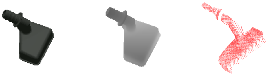
FIGURE 4.9 – Pièce en RGB (gauche) avec sa profondeur P_D (centre) et sa rétro-projection par \Pi^{-1} (droite)
