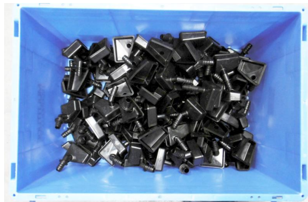
FIGURE 1 – Vue de dessus d'un bac de pièces plastiques (parties de boîte à air de moteur).
