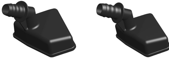
FIGURE 5.3 – Effet d'une caméra télécentrique (gauche) et entocentrique (droite).
