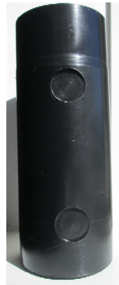
FIGURE 3.6 – Combustible PEHD de 240 mm de long et possédant un diamètre de canal central de 25 mm
