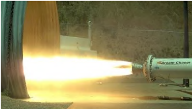
FIGURE 1.12 – Conditions extrêmes au sein de la chambre d'un moteur hybride, montrées par la flamme de diffusion sortant de la tuyère[120]
