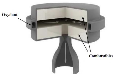
FIGURE 2.1 – Moteur hybride à régression axiale[60]
