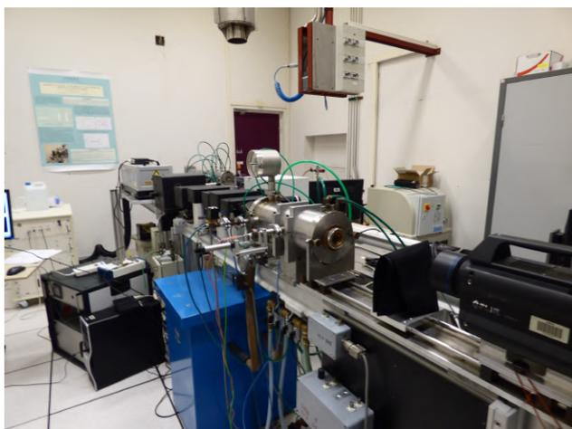
FIGURE E.1 – Diffusimètre thermique laser
