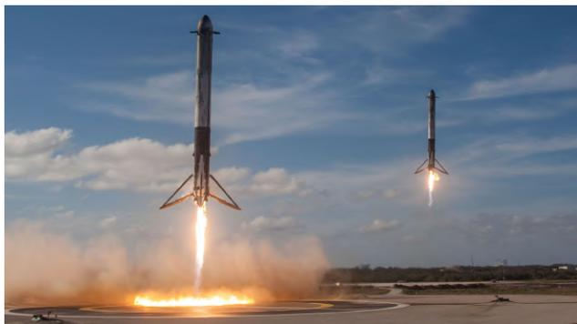
FIGURE 1.1 – Récupération des boosters latéraux du Falcon Heavy[5]
