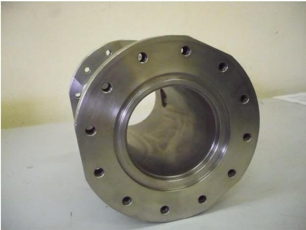
FIGURE 3.5 – Virole de la chambre de combustion du moteur HYCAT
