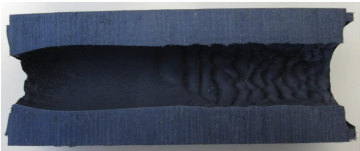
FIGURE 3.25 – Découpe longitudinale du bloc de combustible de l'essai HYCAT 25
