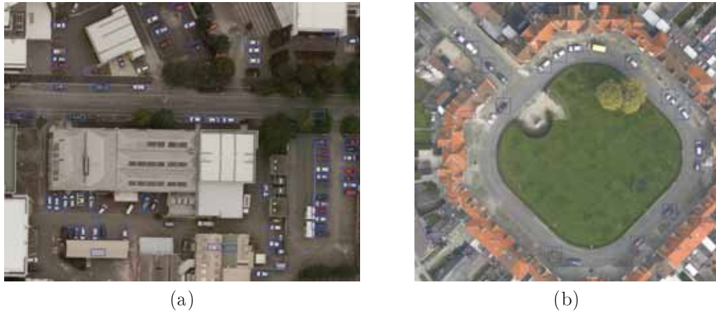
FIGURE 2.5 – Détection d’objet en milieu urbain par DtMM sur les jeux de données (a) NZAM de Christchurch et (b) DFC2015 sur Zeebrugge. Les véhicules selon différentes orientations sont retrouvés par des composantes différentes du mélange de modèles estimé par un GMM. Source : [CI-21].
