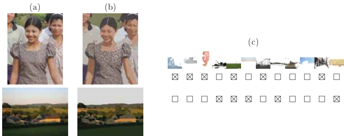
FIGURE 1.5 – Construction des vecteurs d'occurrence de régions : l'image originale (a) est tout d'abord segmentée (b) puis les régions sont mises en correspondance avec les classes du dictionnaire (voir figure 1.4) pour construire le vecteur booléen d'occurrences de régions. Source : [CI-5, CI-6].
