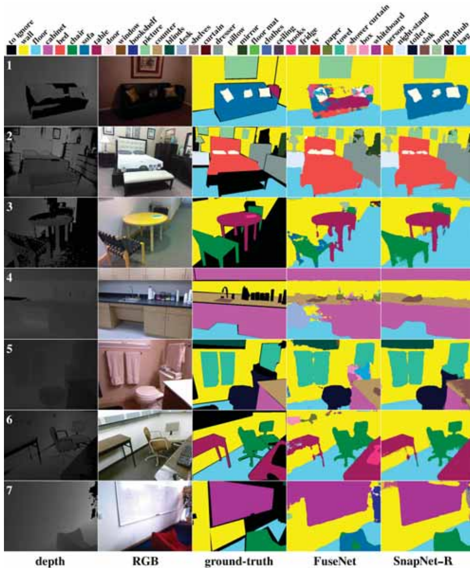
FIGURE 1.13 – Résultats de SnapNet-R pour la segmentation sémantique sur des images de la base SUNRGBD . Source : [CI-34].
