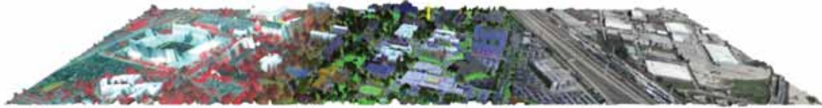
FIGURE 2.19 – Données multimodales 3D du DFC2018. Le nuage de points acquis sur Houston, Texas, USA, est coloré (de gauche à droite) par les fausses couleurs de l’image hyperspectrale, les fausses couleurs du LiDAR multispectral et les couleurs RGB de l’imagerie THR à 5cm/pixel.
