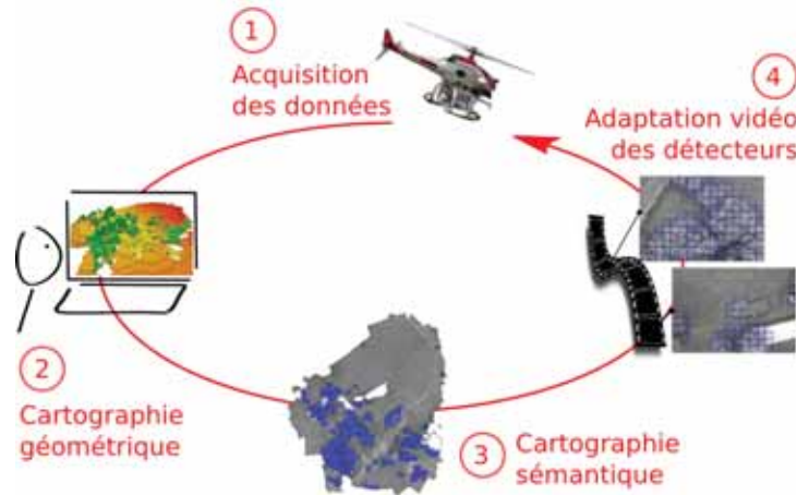
FIGURE 1.8 – Notre approche d'apprentissage interactif pour l'analyse de scène depuis un drone. (1) le drone collecte vidéos, 3D issue d'un LiDAR et positions GPS. (2) Une carte 3D de l'environnement est construite sur la station sol par ajustement de faisceaux global. (3) L'interprète construit des classificateurs ad hoc pour la vue d'ensemble de la scène. (4) Les classificateurs sont adaptés géométriquement au format de la caméra embarquée pour utilisation en vol, connaissant la position courante. Source : [CI-16]
