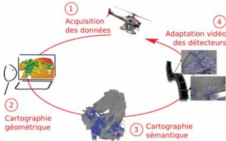
FIGURE 1.8 – Notre approche d'apprentissage interactif pour l'analyse de scène depuis un drone. (1) le drone collecte vidéos, 3D issue d'un LiDAR et positions GPS. (2) Une carte 3D de l'environnement est construite sur la station sol par ajustement de faisceaux global. (3) L'interprète construit des classificateurs ad hoc pour la vue d'ensemble de la scène. (4) Les classificateurs sont adaptés géométriquement au format de la caméra embarquée pour utilisation en vol, connaissant la position courante. Source : [CI-16]
