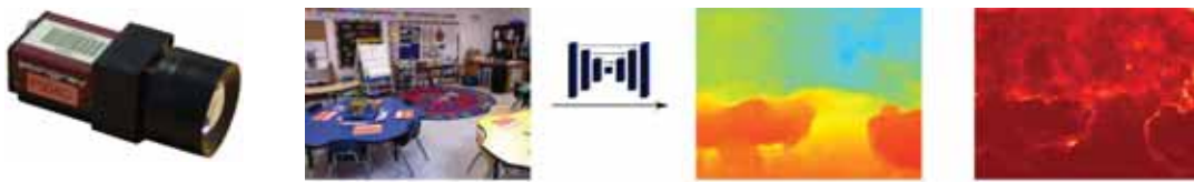
FIGURE 3.4 – Deep Depth from Defocus : estimation de profondeur mono-image par flou de défocalisation et apprentissage profond, avec mesure de l'incertitude de prédiction du modèle. Source : [CI-40].
