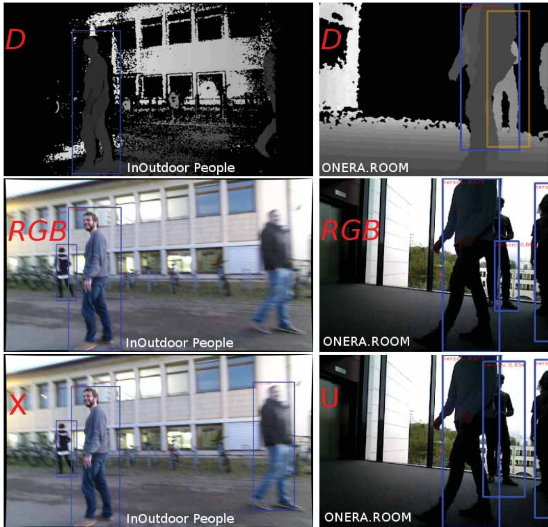
FIGURE 1.14 – Exemples de prédictions de nos méthodes multimodales pour la détection d’objets RGB-D. Les modèles sont entraînés sur InOutdoor RGBD People [74] et testés sur InOutdoor RGBD People et ONERA.ROOM .
