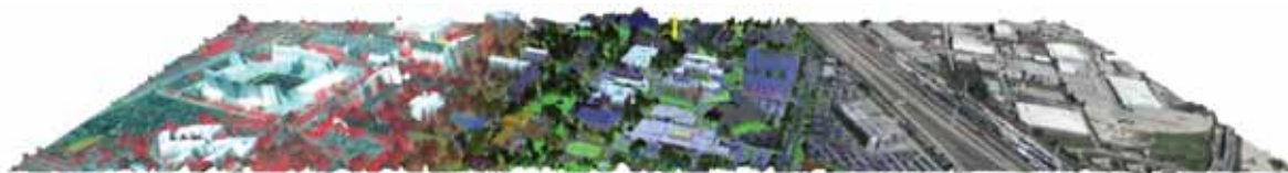
FIGURE 2.19 – Données multimodales 3D du DFC2018. Le nuage de points acquis sur Houston, Texas, USA, est coloré (de gauche à droite) par les fausses couleurs de l’image hyperspectrale, les fausses couleurs du LiDAR multispectral et les couleurs RGB de l’imagerie THR à 5cm/pixel.
