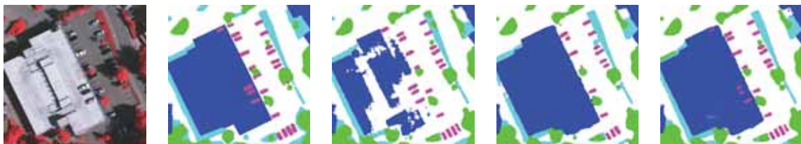
FIGURE 2.9 – Segmentation sémantique multimodale avec correction résiduelle. De gauche à droite, extrait d'une image IR/R/G de ISPRS Vaihingen, référence, segmentation sans MNE par SegNet [55], segmentation avec MNE par FuseNet [59] et par notre approche avec correction résiduelle [RI-11]. Source : [RI-11].
