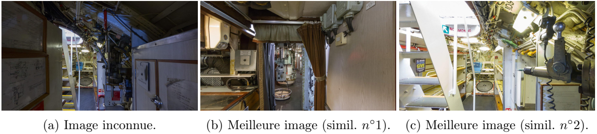
FIGURE 1.7 – Illustration du comportement des deux mesures de similarité utilisées dans notre méthode, en présence d'un fort changement de point de vue. La mesure de similarité globale ( n^{\circ}1 ) capture la structure générale de l'image, tandis que la mesure de similarité basée boîtes ( n^{\circ}2 ) permet de tenir compte des régions communes aux deux images.
