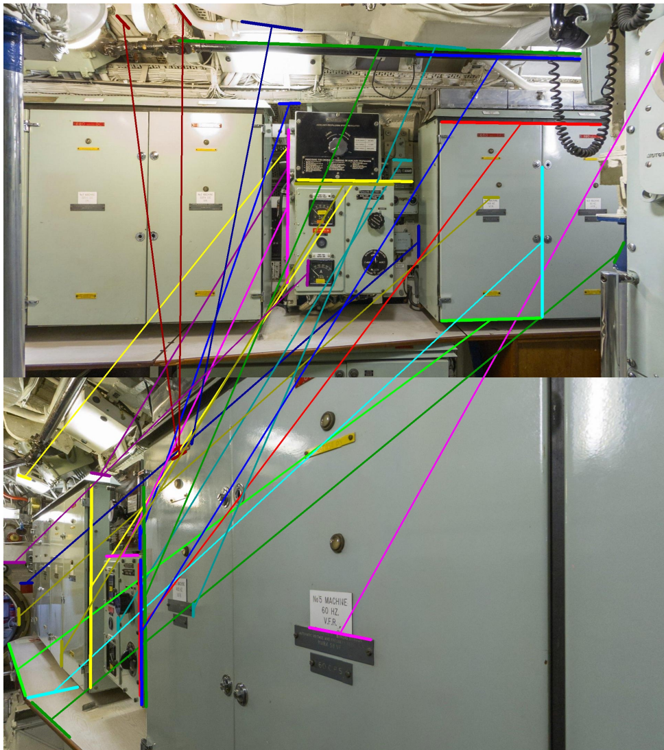
FIGURE 1.12 – Illustration de la difficulté à mettre en correspondance des segments sur la base de leurs descripteurs, en environnement industriel (segments extraits par [SMM16a], puis mis en correspondance par [ZK13]).
