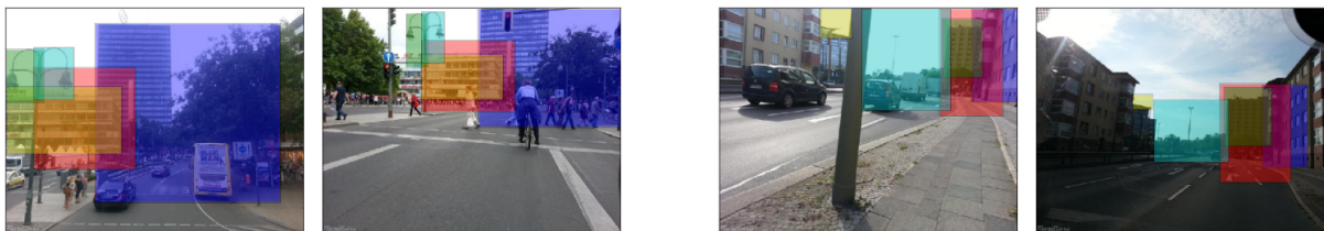
FIGURE 1.4 – Exemples de sous-images extraites puis mises en correspondance automatiquement sur la base de descripteurs CNN : une couleur par correspondance (tirée de [SSJ + 15]).
